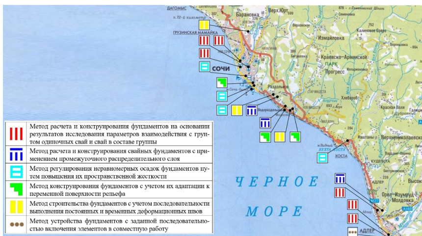
Рисунок 25 – Карта-схема города Сочи (часть карты) с привязкой разработанных автором методов строительства фундаментов в особых условиях (применительно к реализованным многоэтажным и высотным зданиям)
