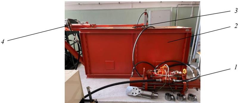
Рис. 1. Стенд для испытаний опытного образца бурильной головки с встроенным генератором гидродинамических колебаний в комплекте со сменными корпусами, оснащенными различными наборами колебателей
