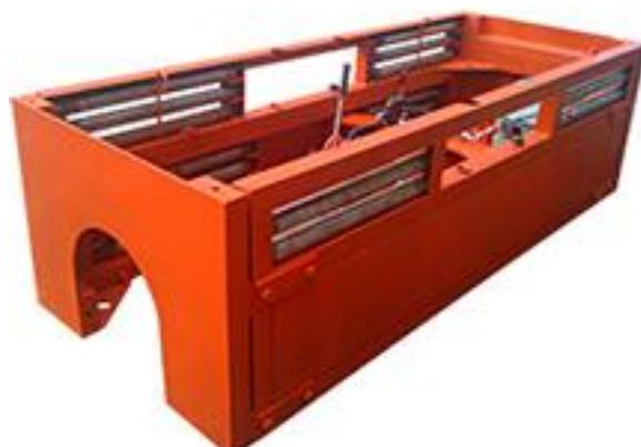
Рисунок 1.5 – Установка для направленного прокола УНП-40Б
