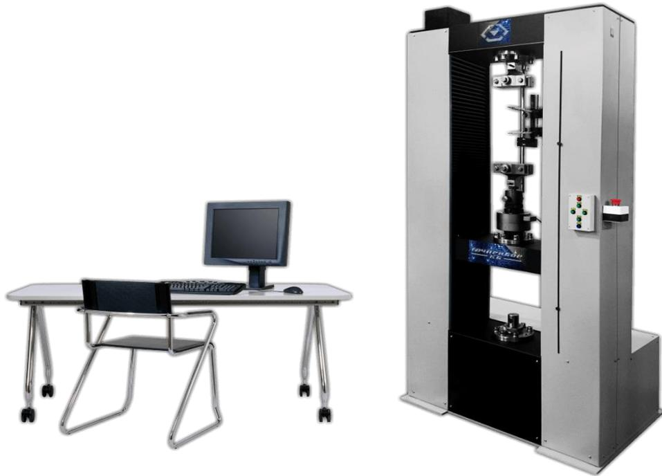
Рисунок 2.8 – Машина для испытаний конструкционных материалов И2143М
