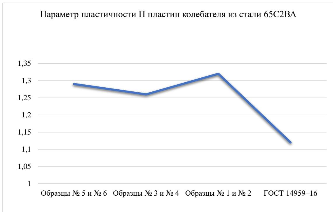
Рисунок 3.12 – Сравнительная характеристика параметра пластичности  $\Pi$  пластин колебателя из стали 65С2ВА
