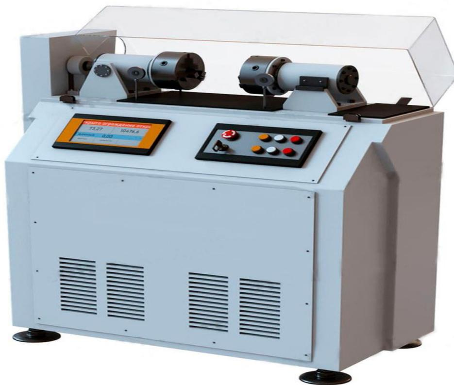
Рисунок 2.10 – Машина для испытания на многоцикловую усталость МУИ-6000
