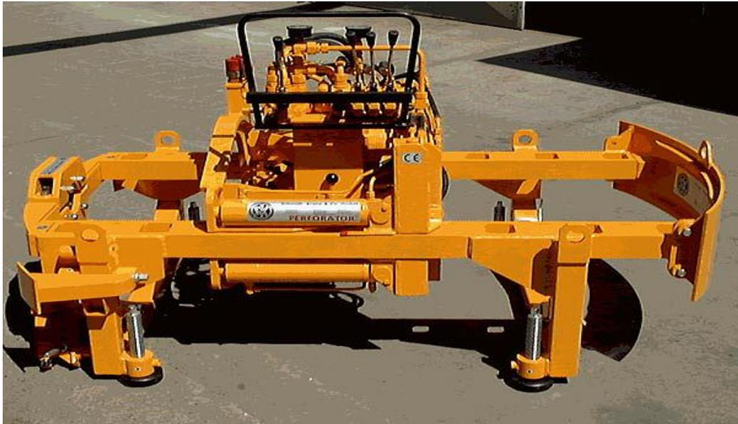
Рисунок 1.9 – Установка горизонтального бурения Perforator РВА-20
