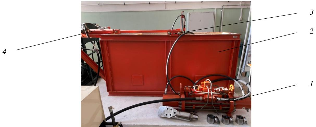
Рисунок 3.15 – Стенд для испытаний опытного образца бурильной головки со встроенным генератором гидродинамических колебаний в комплекте со сменными корпусами, оснащенными различными наборами колебателей
