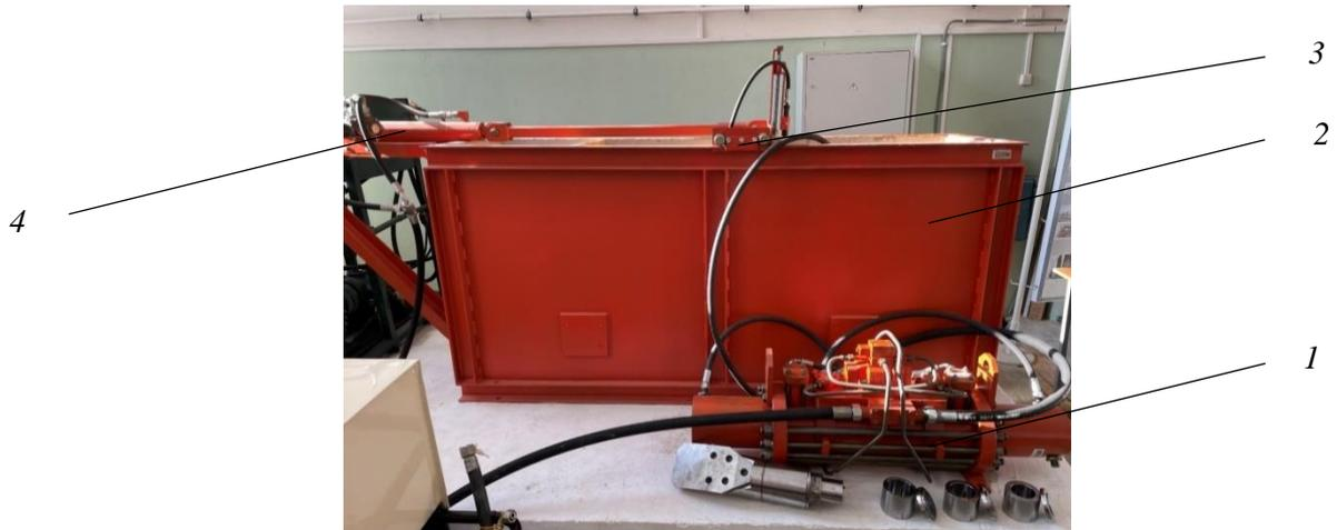
Рисунок 2.11 – Стенд для испытаний опытного образца бурильной головки со встроенным генератором ГК в комплекте со сменными корпусами, оснащенными различными наборами колебателей
