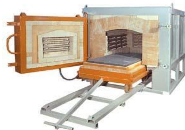
Рисунок 2.2 – Печь для отжига, нормализации и закалки ПВП 300/12,5 «Накал».
