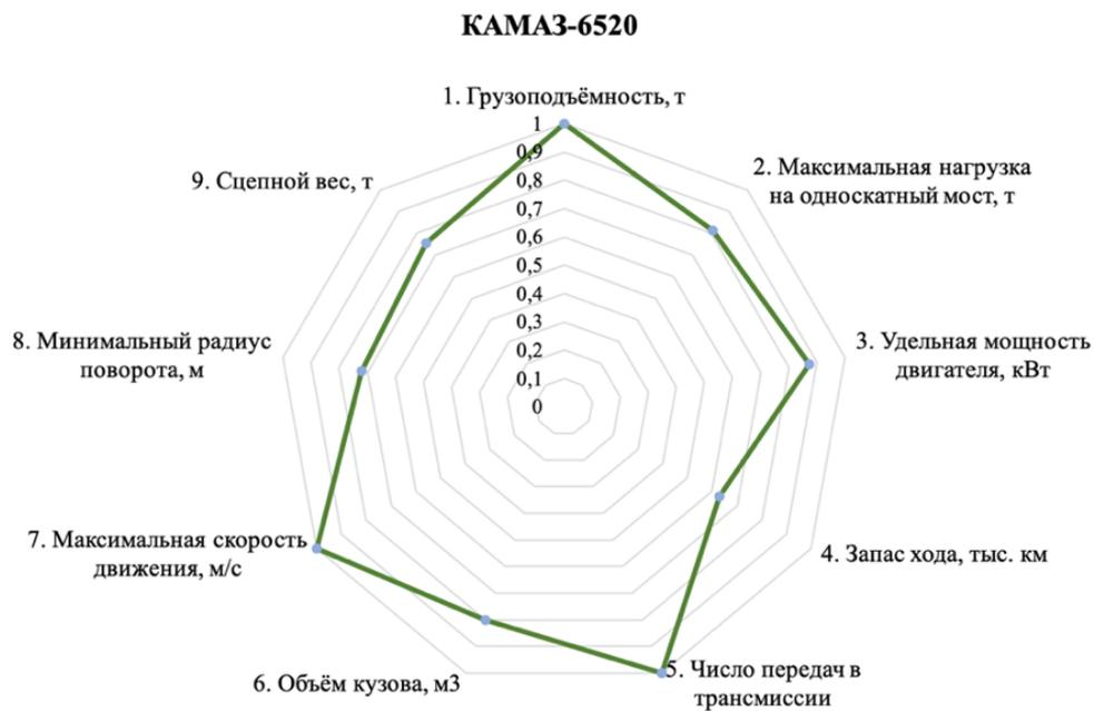
Рисунок 2.2. Лепестковая диаграмма относительных показателей автосамосвала КАМАЗ-6520
