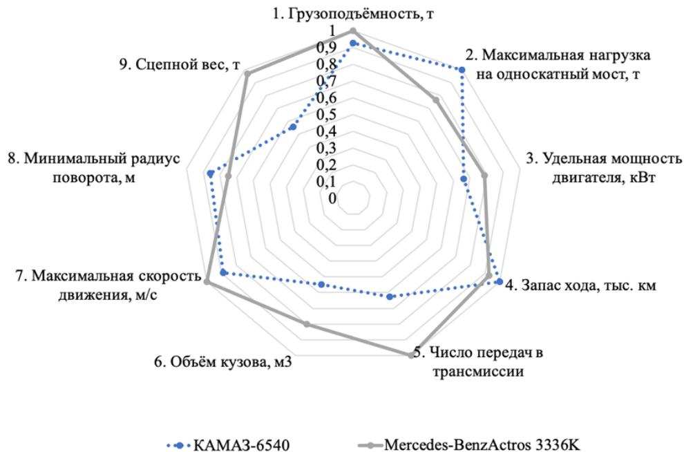
Рисунок 2.3. Лепестковые диаграммы эксплуатационных свойств лидирующего европейского и наиболее отстающего отечественного образцов
