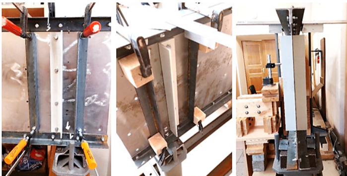
Рисунок 7. Последовательность усиления стальной стенки балки композитными уголками
