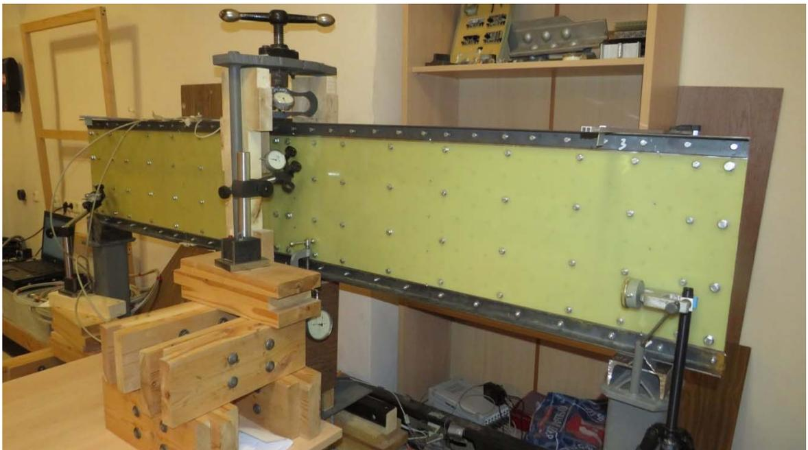
Рисунок 21. Расположение датчиков измерения боковой деформации стенки балки, укреплённой плоскостными композитными элементами прямоугольной формы.
