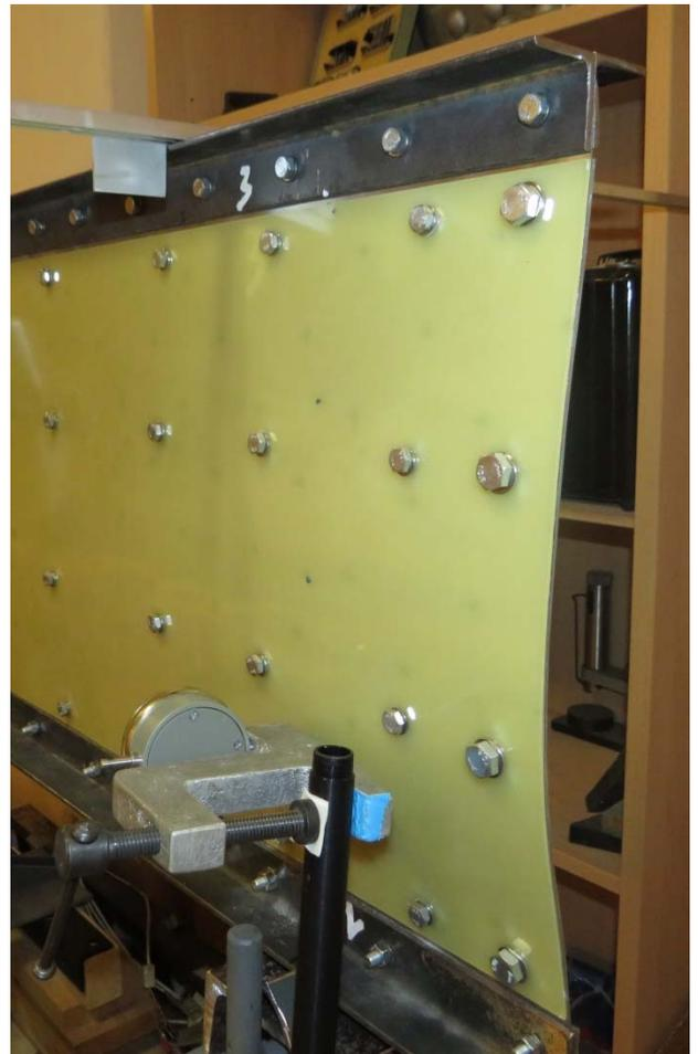
Рисунок П.4.5. Деформация стальной стенки балки над правой опорой при значении нагружения  $F = 1788$  кгс.
