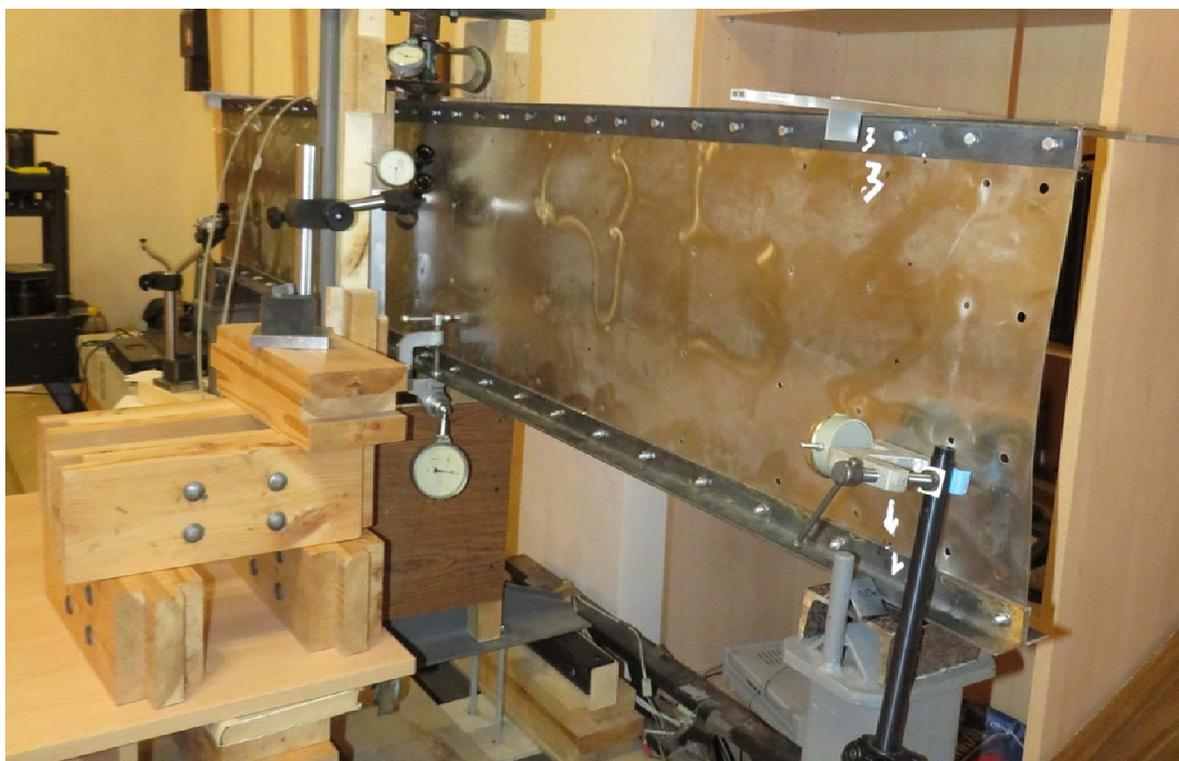
Рисунок П.4.1. Деформация стальной стенки балки при значении нагрузки  $F = 475,8$  кгс.
