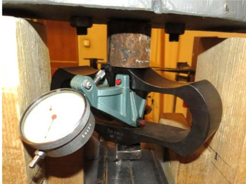
Рисунок 19. Динамометр ДОСМ 3-3 с индикатором измерения часового типа.
