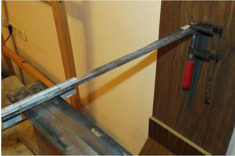
Рисунок 16. Раскрепление верхнего пояса балки над левой опорой из плоскости действия М изг.
