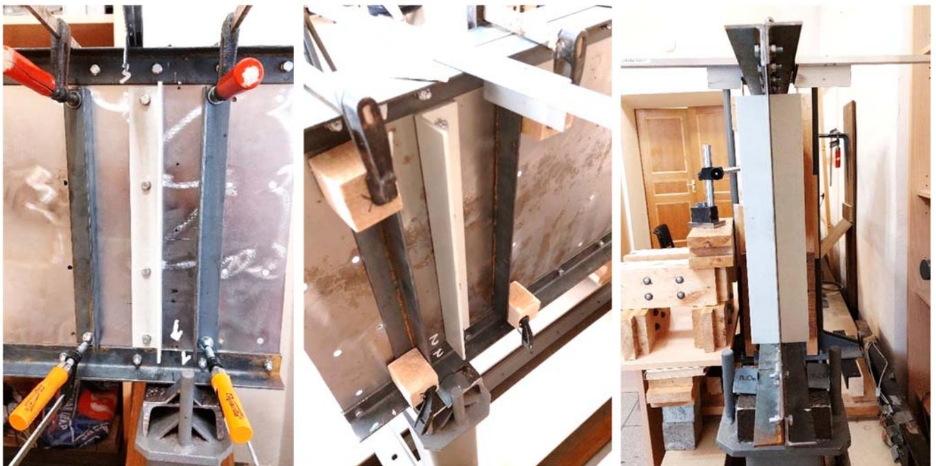
Рисунок 40. Усиление стальной стенки балки композитными уголками.
