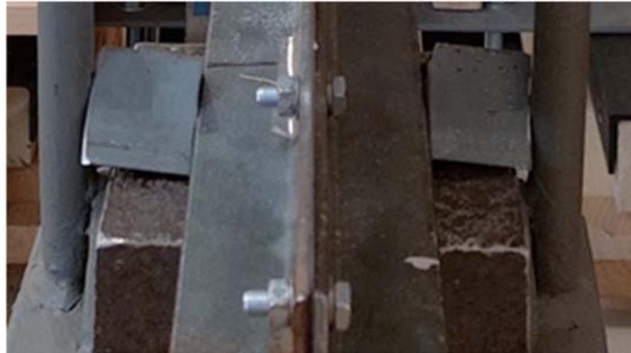
Рисунок 18. Раскрепление нижнего пояса из плоскости балки стальными упорами.
