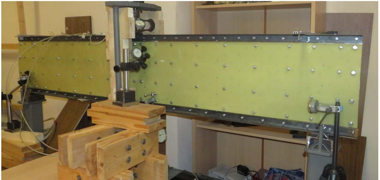
Рисунок П.4.3. Деформация стальной стенки балки при значении нагружения  $F = 1788$  кгс .
