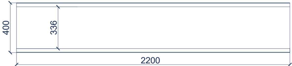
Рисунок 24. Схема стальной балки, выполненной без усиления стенки.
