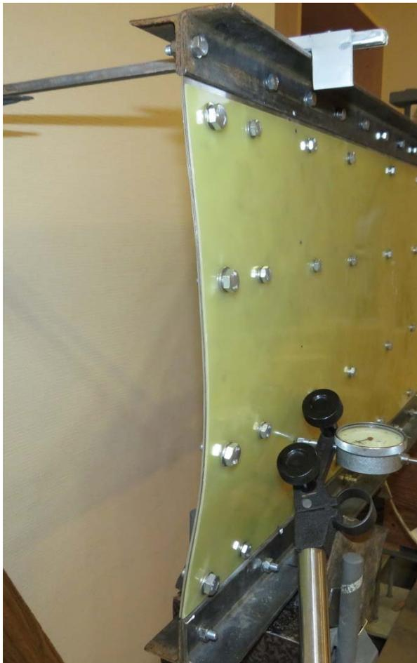
Рисунок П.4.4. Деформация стальной стенки балки над левой опорой при значении нагружения  $F = 1788$  кгс.
