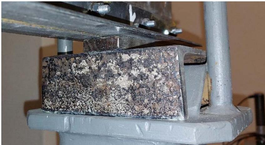
Рисунок 13. Узел опирания нижнего пояса стальной балки.
