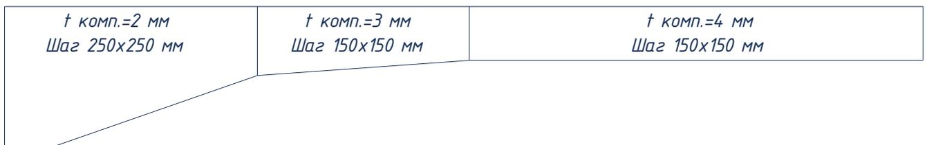
Рисунок П.5.8. Уточнённая форма плоскостных элементов (левая половина), состоящих из отдельных пластин разной толщины с указанием допустимого шага расстановки болтовых соединений.
