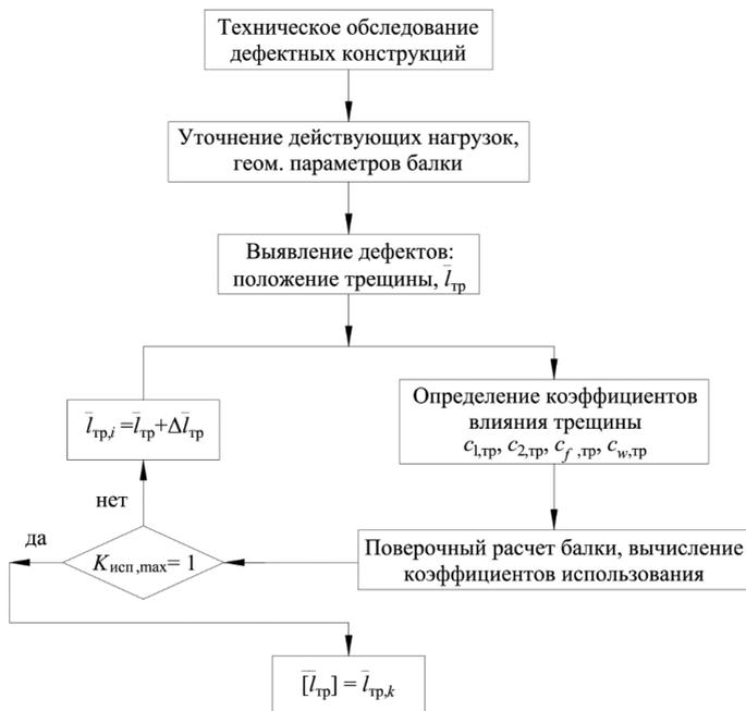
Рис. 12. Алгоритм определения предельной длины трещины
