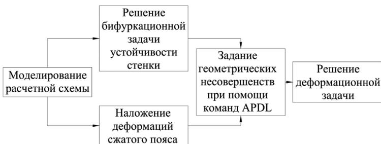
Рис. 4. Алгоритм определения напряженно-деформированных состояний поврежденных подкрановых балок с учетом геометрических несовершенств
