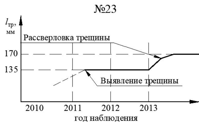
Рисунок 4.10. Динамика изменения трещин в верхней зоне стенки подкрановых балок по результатам мониторинга (№19 – №24)
