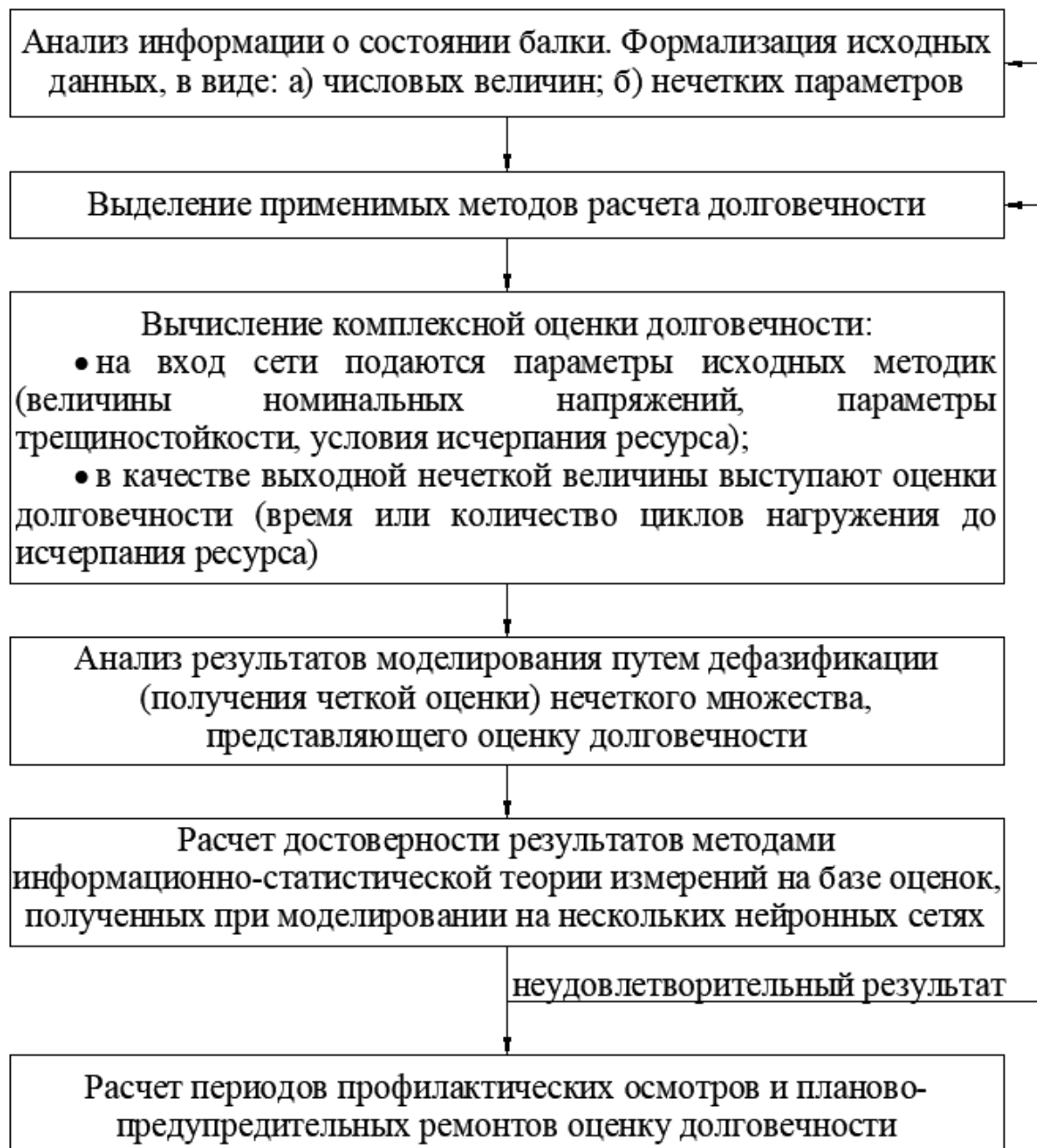
Рисунок 1.6. Алгоритм расчета долговечности поврежденных подкрановых балок.
