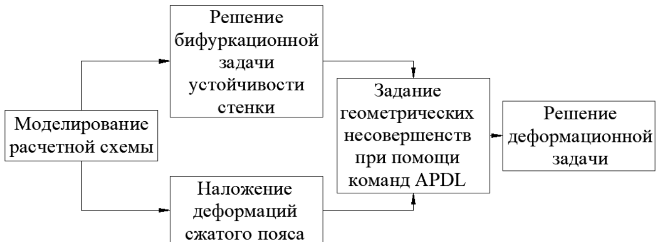
Рисунок 2.13. Блок-схема алгоритма определения напряженно-деформированного состояния поврежденной подкрановой балки с учетом геометрических несовершенств
