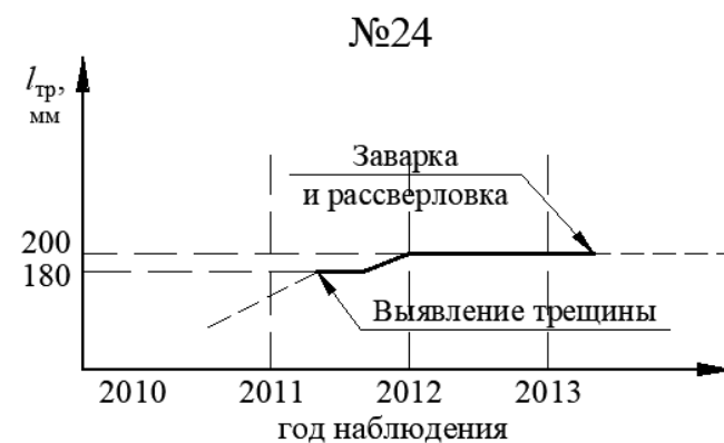
Рисунок 4.10. Динамика изменения трещин в верхней зоне стенки подкрановых балок по результатам мониторинга (№19 – №24)
