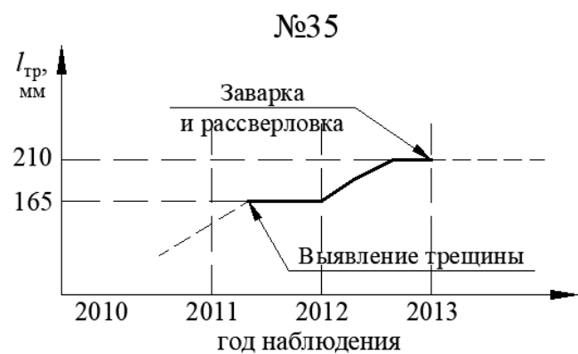
Рисунок 4.12. Динамика изменения трещин в верхней зоне стенки подкрановых балок по результатам мониторинга (№31 – №35)
