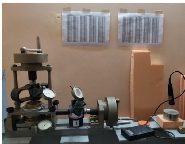
Рис. 3.16. Процесс определения мгновенной прочности смерзания а) на приборе ВСВ-25 по ГОСТ 12248 б) по авторской методике [42]
