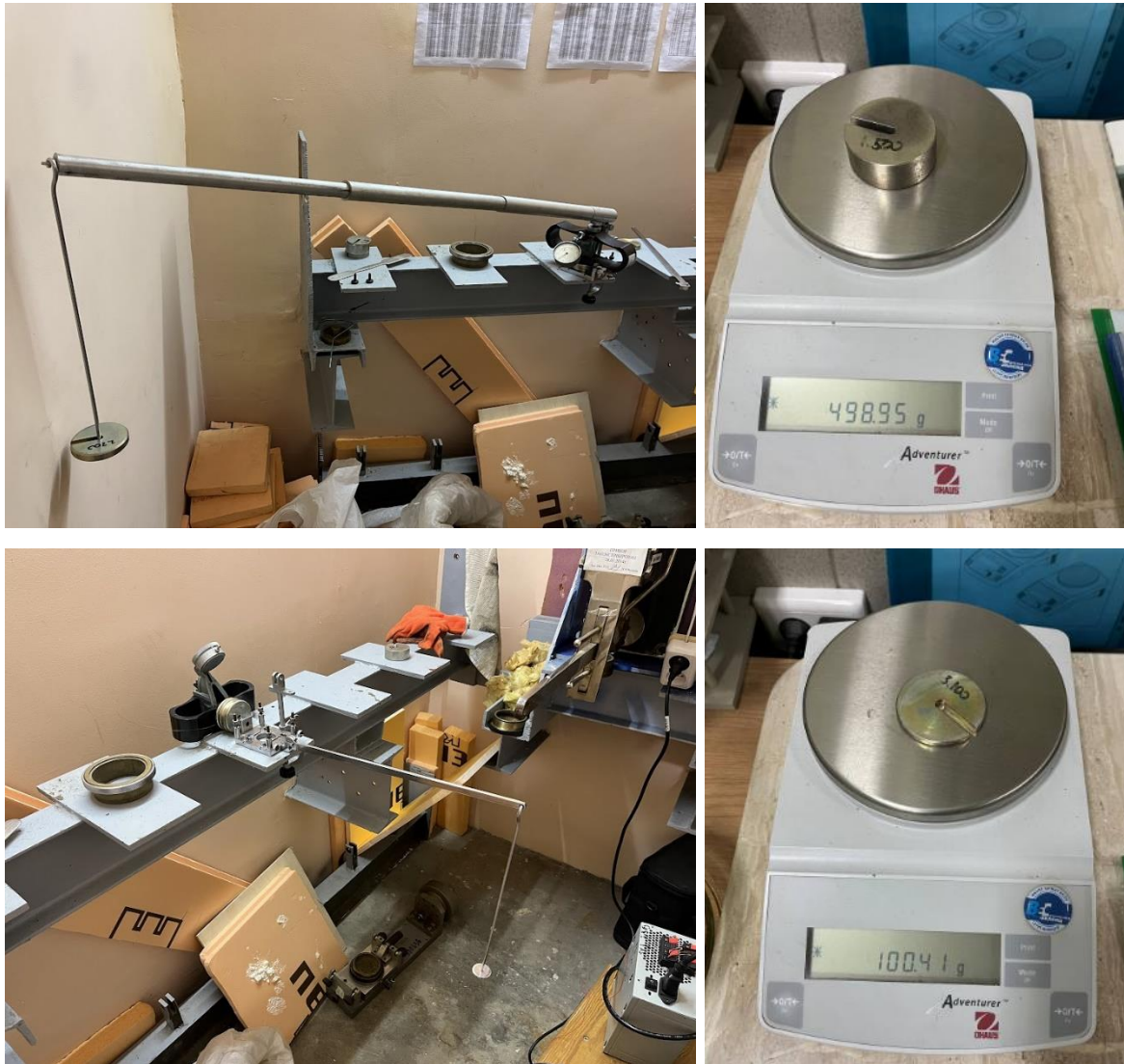
Рис. 3.21. Уточнение массы грузов и соотношения плеч рычажной системы полевой лаборатории Литвинова
