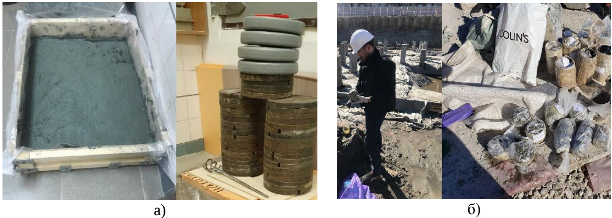
Рисунок 2 – Создание грунта нарушенной структуры (а) отбор грунта ненарушенной структуры (б)
