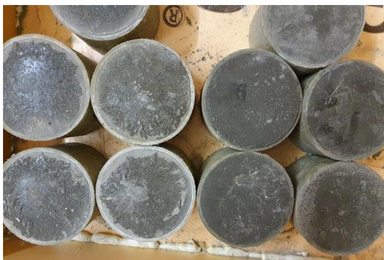
Рисунок 8 – Образцы, замороженные без утепления (слева) и с утеплением (справа)
