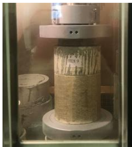
Рис. 3.16. Процесс определения мгновенной прочности смерзания а) на приборе ВСВ-25 по ГОСТ 12248 б) по авторской методике [42]
