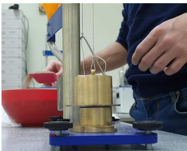
Рис. 3.11. Процесс определения усилия прилипания материала к грунту
