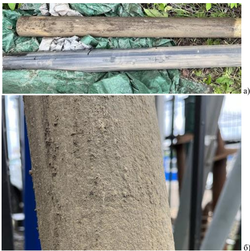
Рис. 4.27. Стальная свая без винта и КПС после испытания. Общий вид (а) и поверхность КПС (б)
