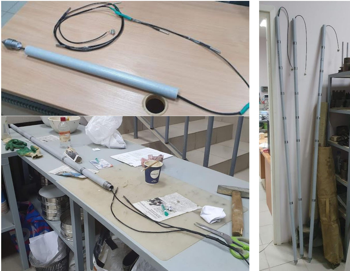
Рис. 4.7. Процесс изготовления термометрической трубки предложенной конструкции
