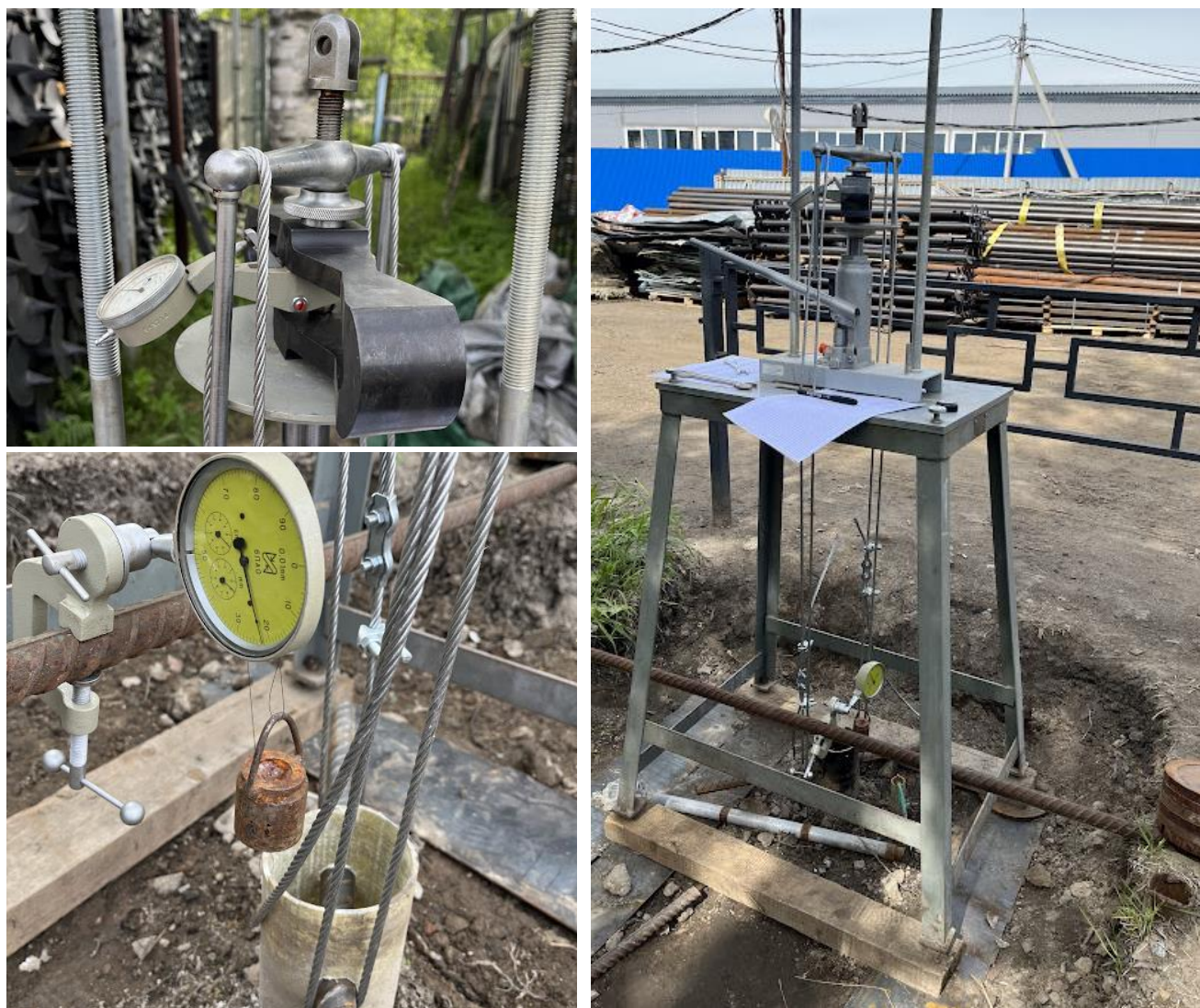
Рис. 4.25. Процесс испытания свай статической выдёргивающей нагрузкой
