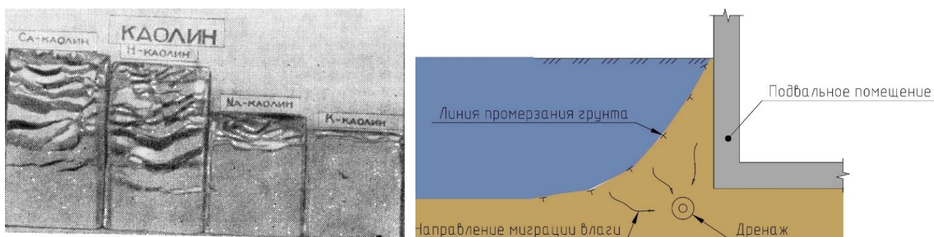
Рис. 1.11. Инженерно-мелиоративные способы защиты фундамента от касательных сил морозного пучения а) Образцы каолина с различным составом обменных катионов [84], б) устройство дренажа для отвода влаги из грунта
