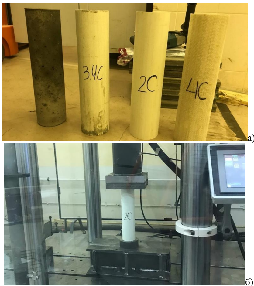
Рис. 4.8. Проведение испытаний образцов на центральное сжатие а) общий вид испытанных образцов, б) процесс испытания
