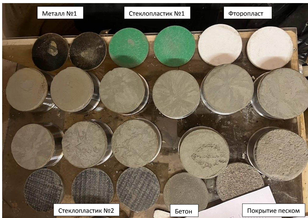
Рис. 2.16. Текстура грунта №1 в мёрзлом состоянии на контакте с материалами 1...5
