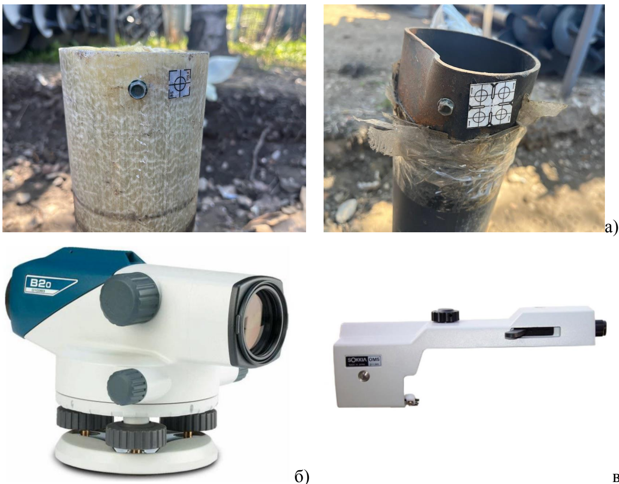
Рис. 4.19. Оборудование, применённое для геодезических наблюдений а) деформационные марки на сваях, б) оптический нивелир SOKKIA B20, в) насадка на оптический нивелир OM5
