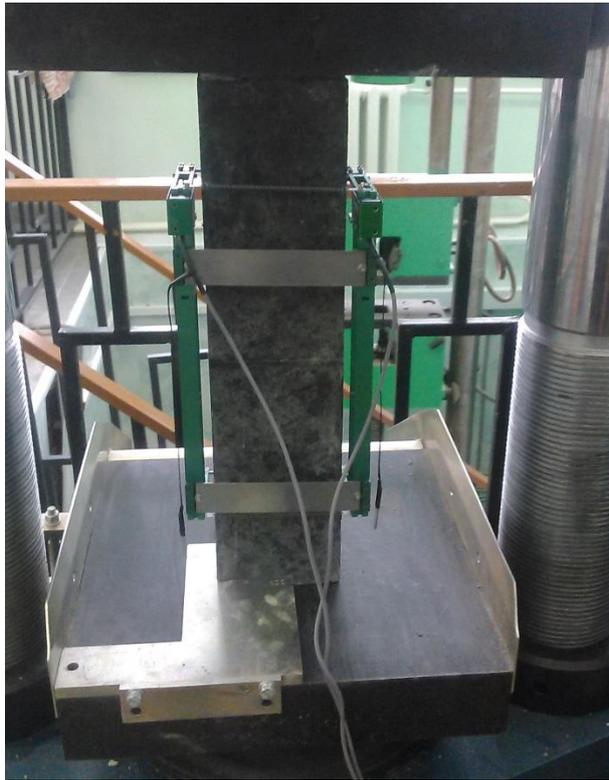
Рисунок 2.2. Образец с установленным экстензометром
