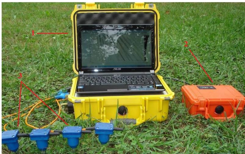
Рис. 3.1. Аппаратно-программный комплекс для проведения исследований: 1 – ноутбук, 2 – станция «Сейсмолог-20» с аккумулятором, 3 – датчики «геофон» GX20DXSUPER.
