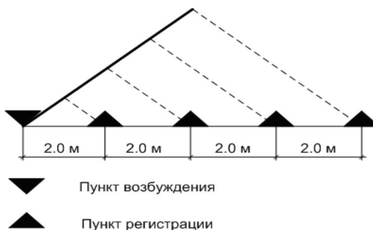
Рис.3.6. Схема расстановки сейсмоприемников при зондировании грунта.
