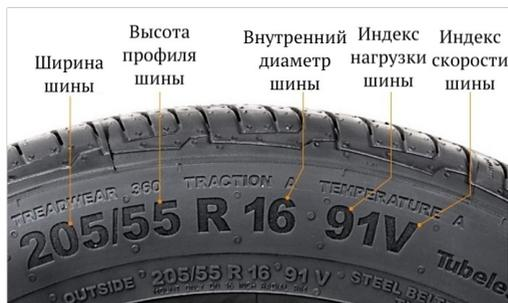
Рисунок 3 – Маркировка шины
