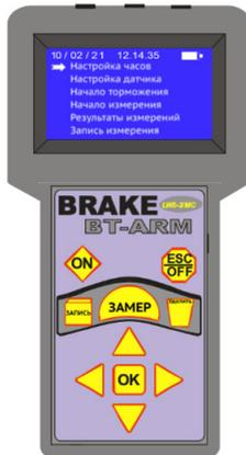
Рисунок 4 – Деселерометр модели «LWS-2МС»
