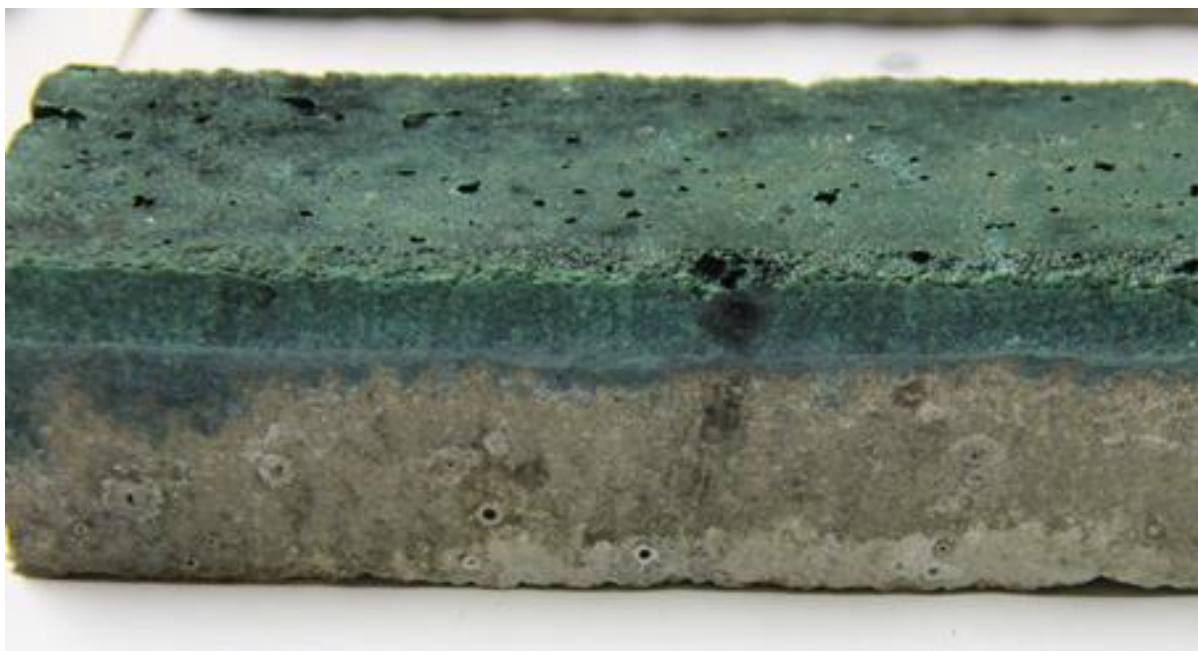
Рис. 2.36. Визуализация уровня поглощения с помощью цветного раствора \text{Cu(II)}
