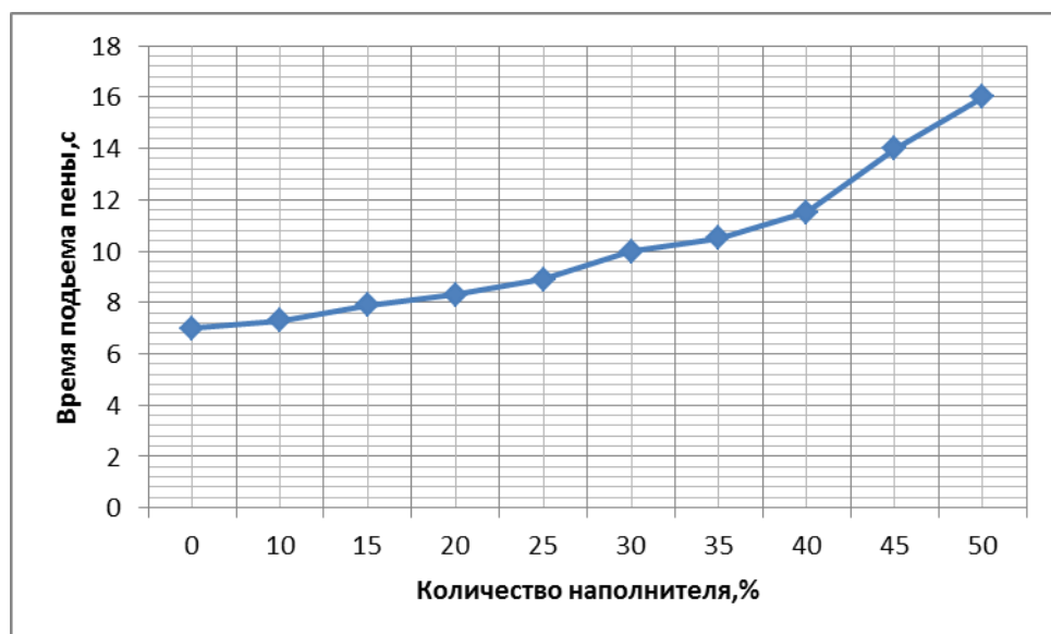
Рисунок 29 – Зависимость времени подъема пены от содержания золы уноса в композиции (доверительный интервал R^2=0.953 )
