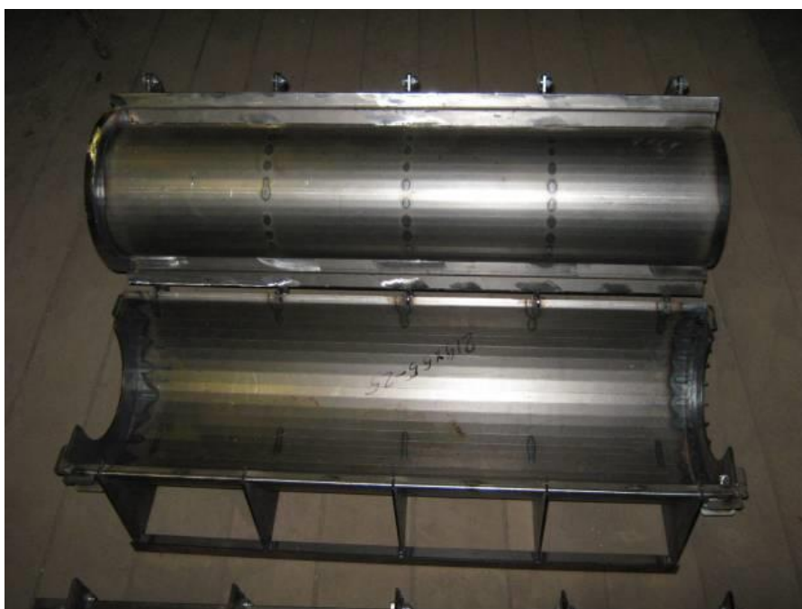
Рисунок 21 – Форма для производства теплоизоляционных скорлуп
