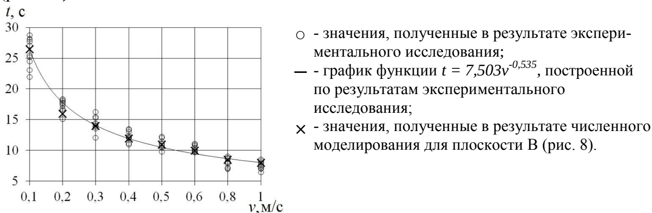
Рис. 10. Зависимость времени стабилизации воздушного потока t от скорости приточного воздуха v
