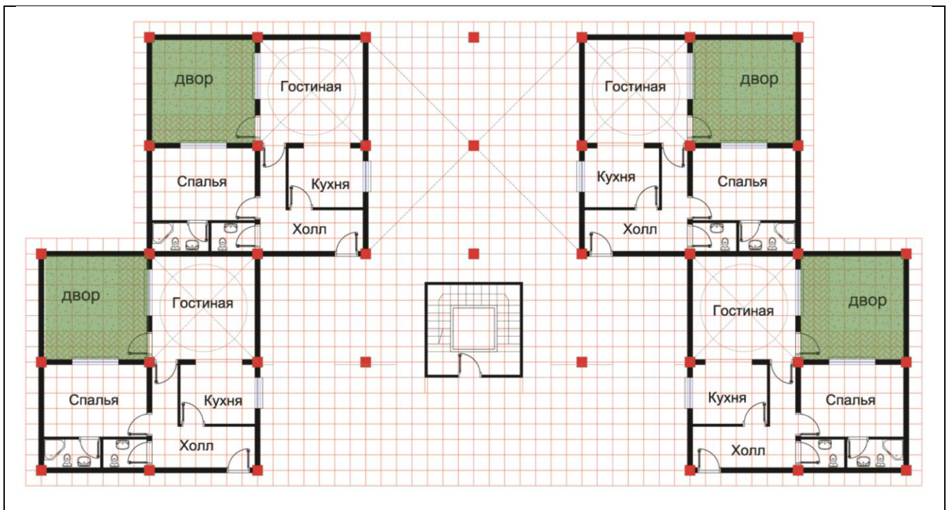
Рисунок В.3.3.7. Формирование жилого комплекса на основе жилых модульных единиц. Первый этаж.
