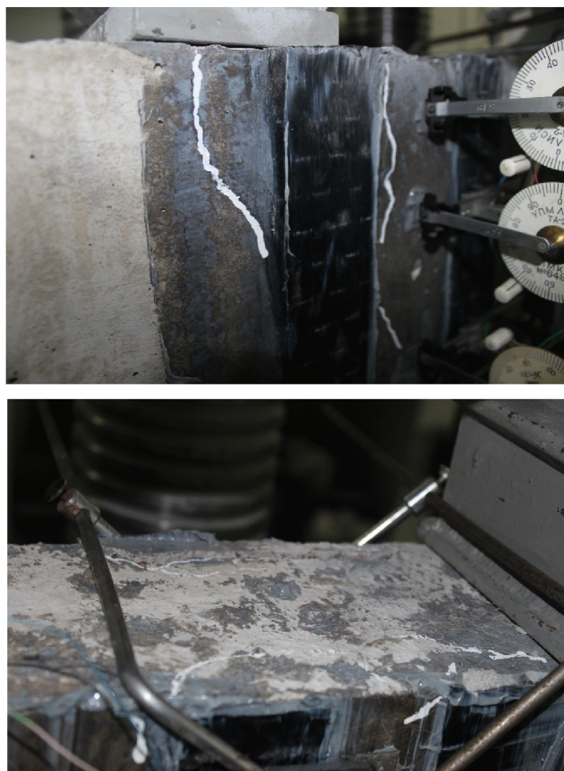
Рис. 3.2.3.2. Формирование поверхности выкола бетона
