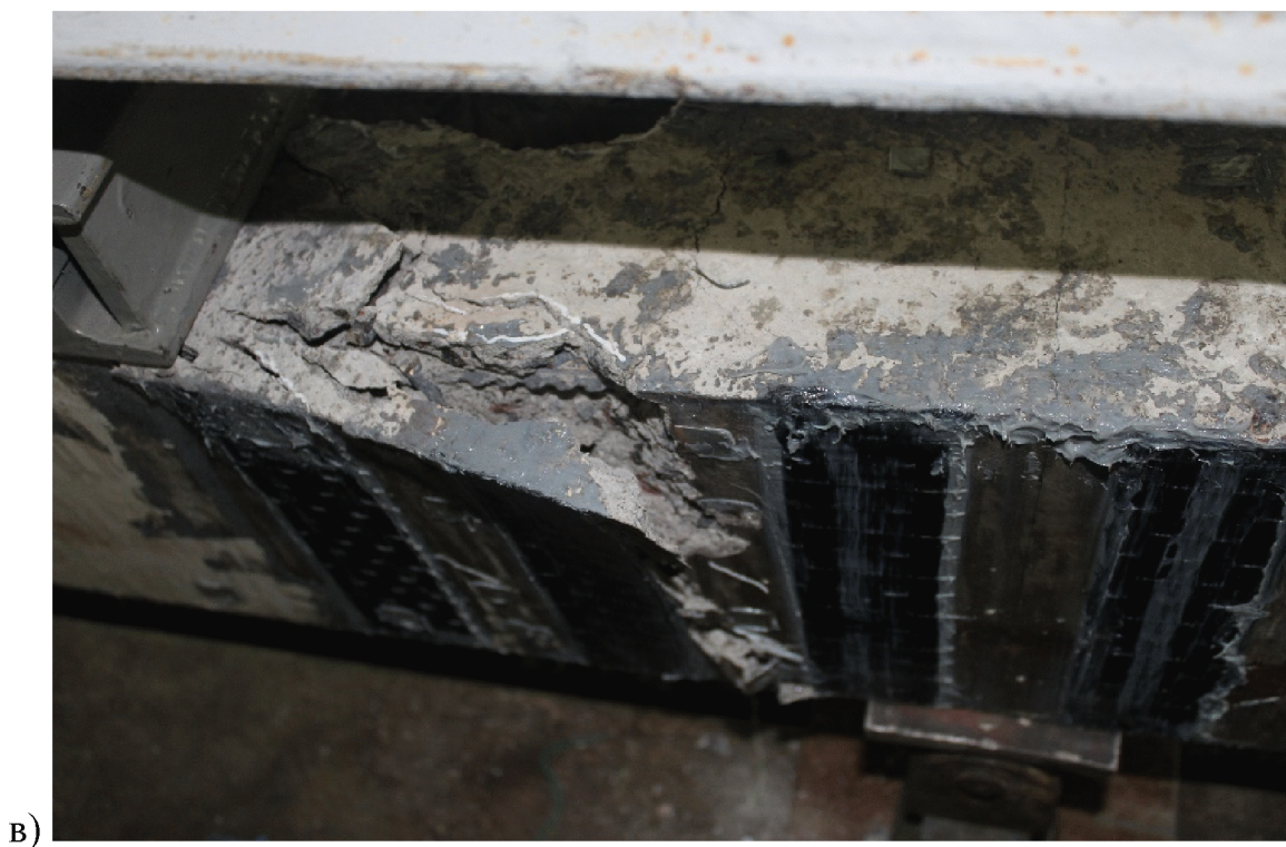
рис.3.2.3.2. Испытуемые образцы после разрушения а) Бм-1.2, б) Бм-2.2, в) Бм-3.2
