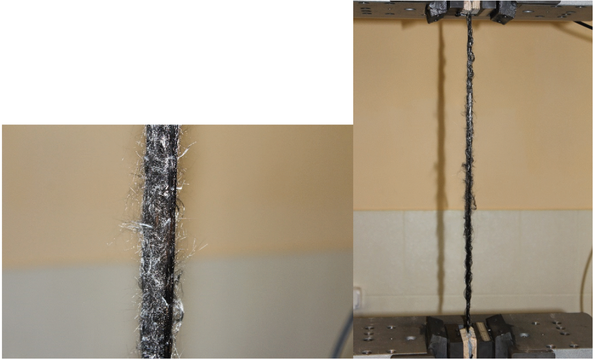
рис.3.1.2.3 Образцы ткани ФАП без пропитки при разрушении.
