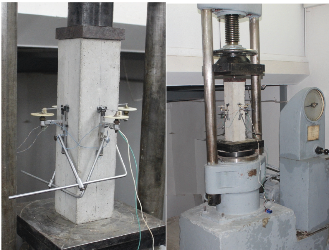
рис.3.1.1.1 Установка для испытания бетонных призм на сжатие.
