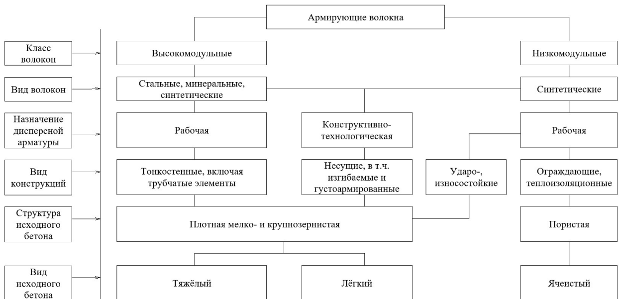
Рисунок 1.2 – Области эффективного использования армирующих волокон [93]
