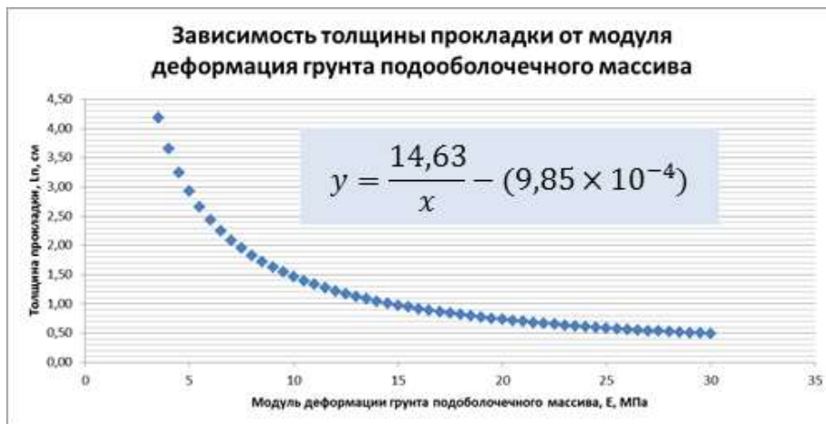
Рисунок 2.6. График зависимости толщины прокладки от модуля деформации грунта подошвочного массива. 1-й вариант
