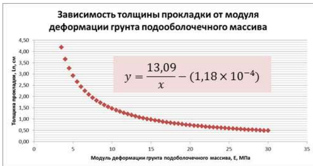
Рисунок 2.8. График зависимости толщины прокладки от модуля деформации грунта подоболоечного массива. 2-й вариант
