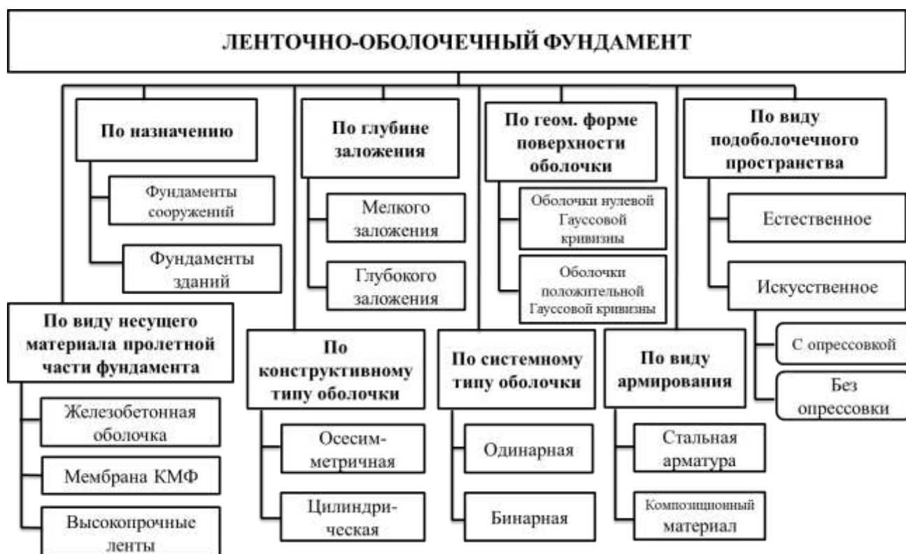
Рисунок 1.15. Классификация ленточно-оболочечных фундаментов с выпуклой вверх формой контактной поверхности в пролетной части
