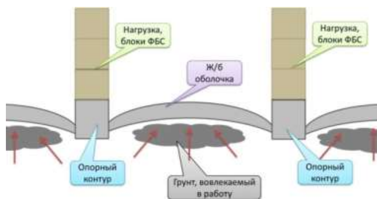
Рисунок 1.7. Схема работы ленточных тонкостенно-оболочечных фундаментов
