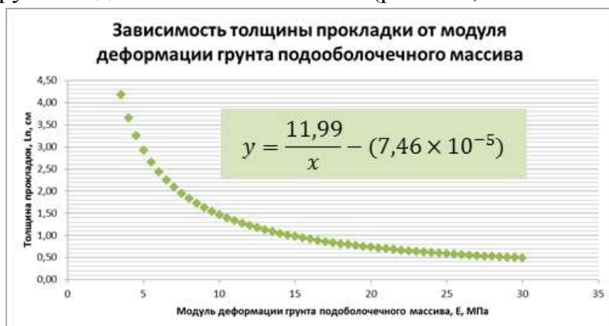
Рисунок 2.10. График зависимости толщины прокладки от модуля деформации грунта подбололочечного массива. 3-й вариант
