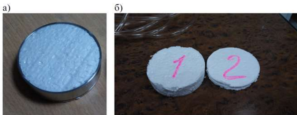
Рисунок 2.15. Компрессионные испытания пенополистирола: а) подготовленный образец в кольце; б) образцы до и после испытаний [49]
