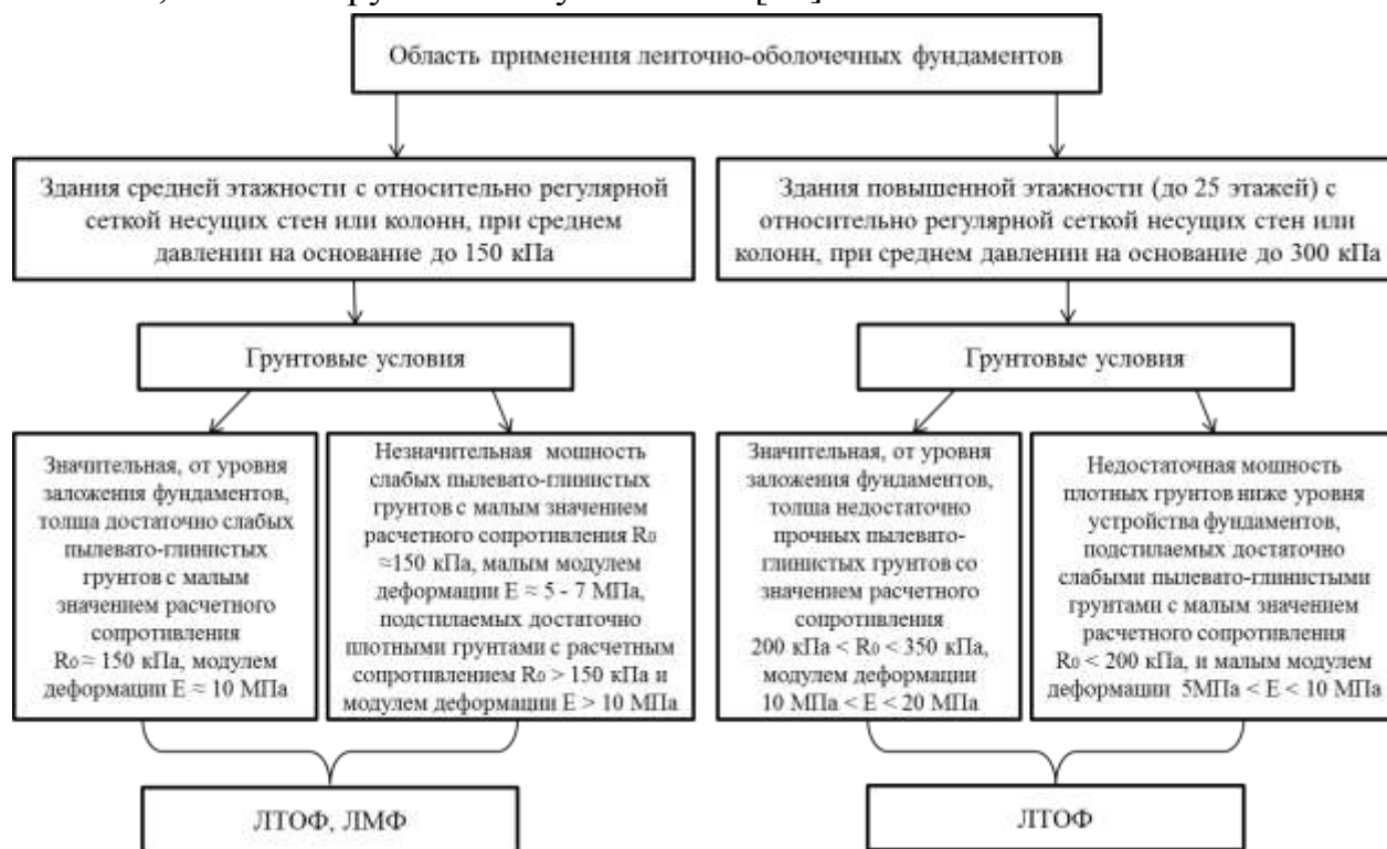
Рисунок 1.5. Область применения ленточно-оболочечных фундаментов
