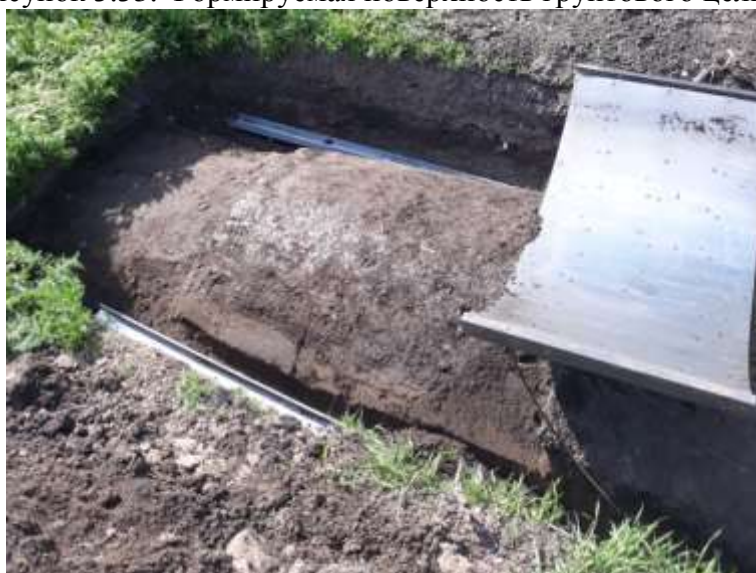
Рисунок 3.34. Поверхность грунтового целика на конечном этапе срезки грунта
