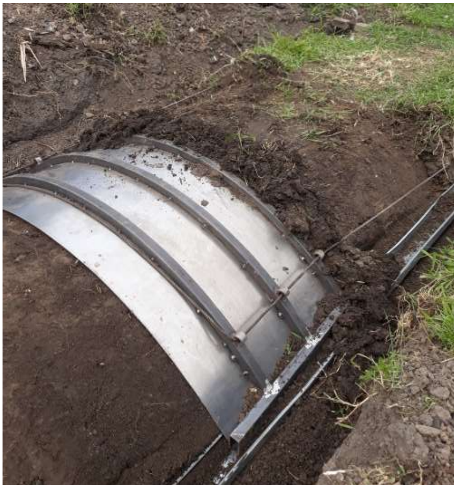
Рисунок 3.32. Движение режущего ножа вдоль направляющих
