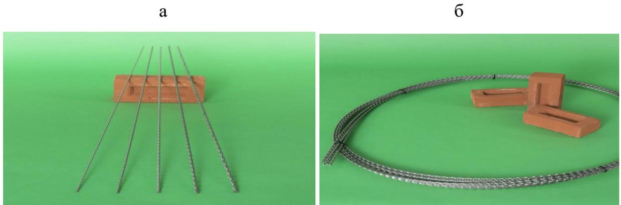
Рисунок 4.32– Спиральные стержни (а) и проволока (б) из нержавеющей стали.
