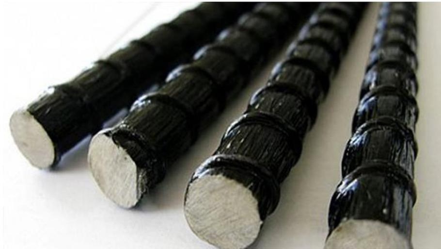
Рисунок 4.33 – Стержни из углеполимера.
