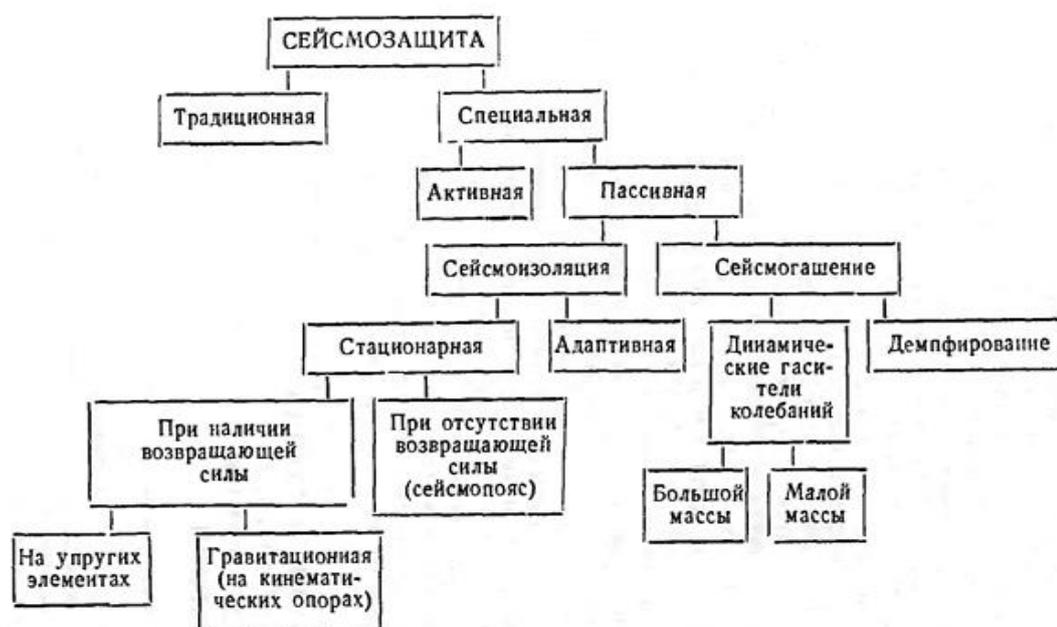
Рисунок 4.15 – Схема– классификация систем сейсмозащиты зданий и сооружений по принципу их работы
