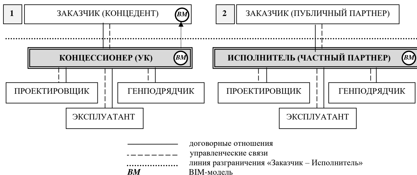
Рисунок 1.4 – Модель организации инвестиционно-строительного процесса через комплексный инжиниринг жизненного цикла объекта (концессия и ГЧП-МЧП)
