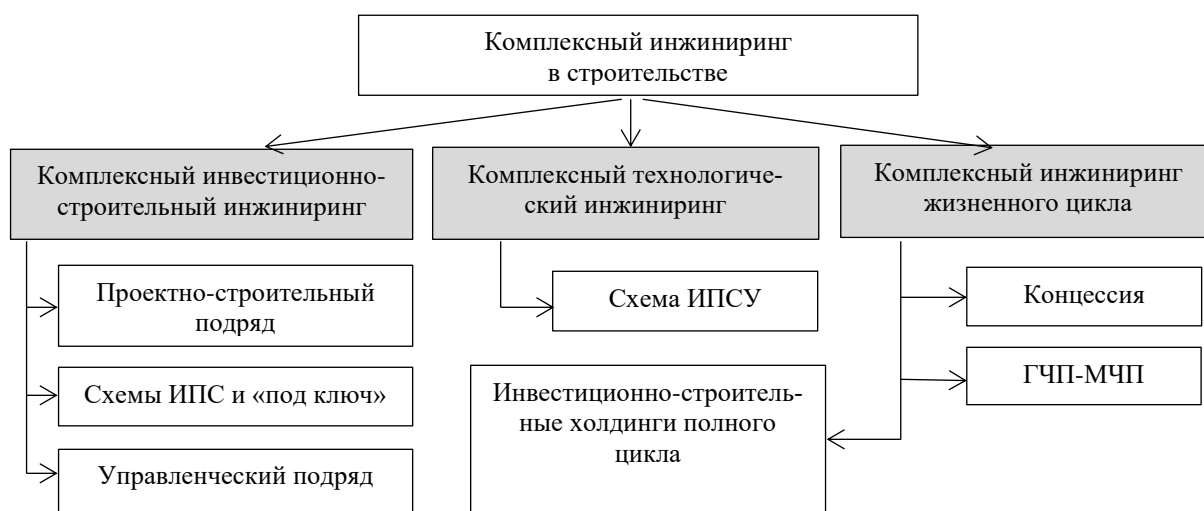
Рисунок 1.5 – Классификация комплексного инжиниринга в строительстве в привязке к моделям и схемам реализации инвестиционно-строительного процесса (авторская разработка)
