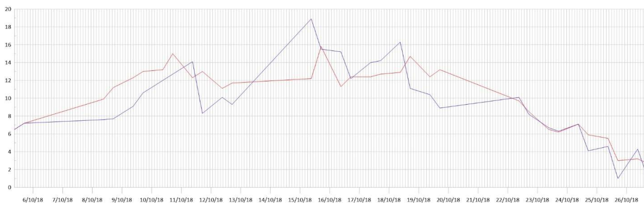
Рисунок 2.9 - Температура воздуха в помещении чердака (красная линия) и на улице в период измерений (синяя линия)
