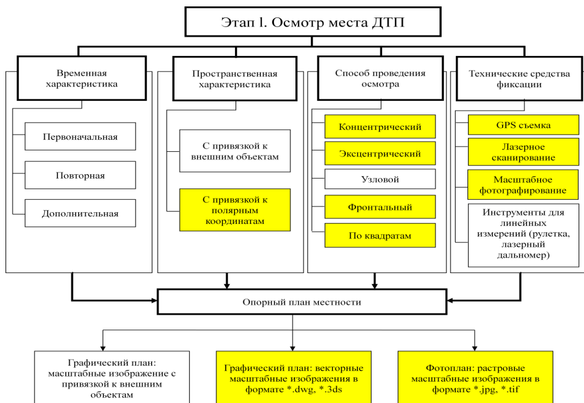
Рис. 10. Уточненная типовая структурная схема осмотра места ДТП
