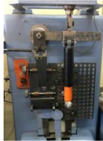
Рис. 6. Испытание амортизатора ТС на стенде «Miletto».
