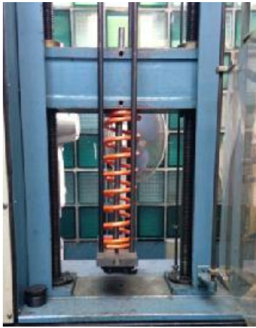
Рис. 5. Испытание пружины подвески ТС на разрывной машине Р-5
