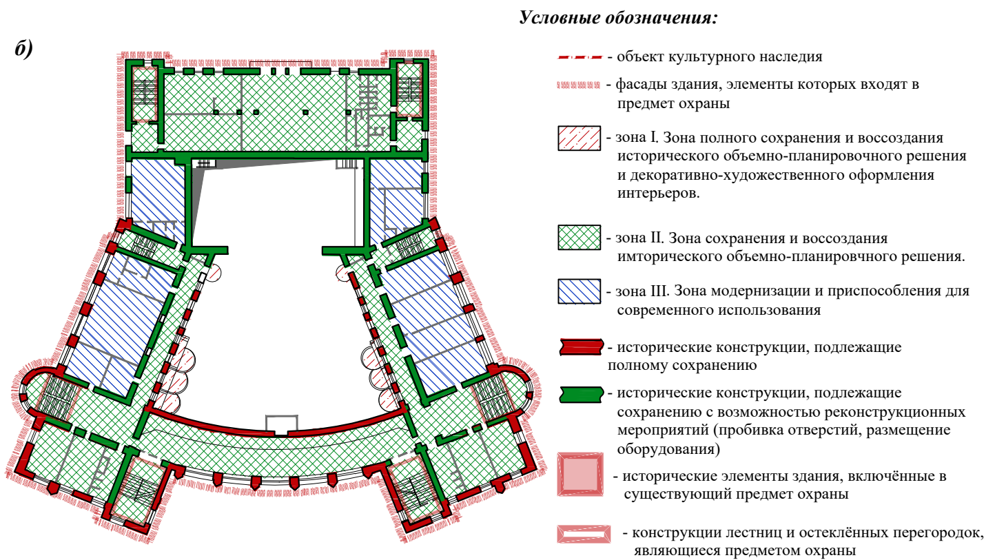
Рисунок В.3.3. Дворец культуры им. А. М. Горького. Схема плана 3 этажа (авторская схема) : а) графический анализ существующего предмета охраны; б) схема предлагаемого предмета охраны
