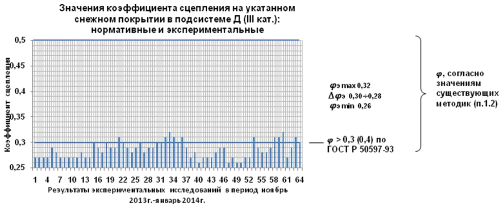
Рисунок 3.44 – Сравнение экспериментально полученных (фактических) значений коэффициента сцепления на укатанном снежном покрытии на участке подсистемы Д – участок а/д «Зеленогорск – Приморск - Выборг» в период с ноября 2013г. по январь 2014г. с нормативными данными, значениями известных авторов и существующих методик
