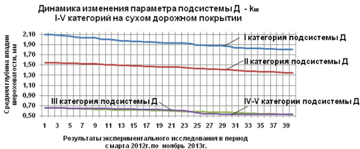
Рисунок 3.47 – Измерение шероховатости сухого дорожного покрытия на экспериментальных участках в период с марта 2012г. по ноябрь 2013г.
