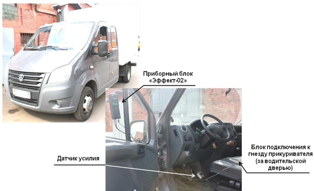
Рисунок 3.5 – Установка прибора и получение результатов исследования на а/м Газель Next
