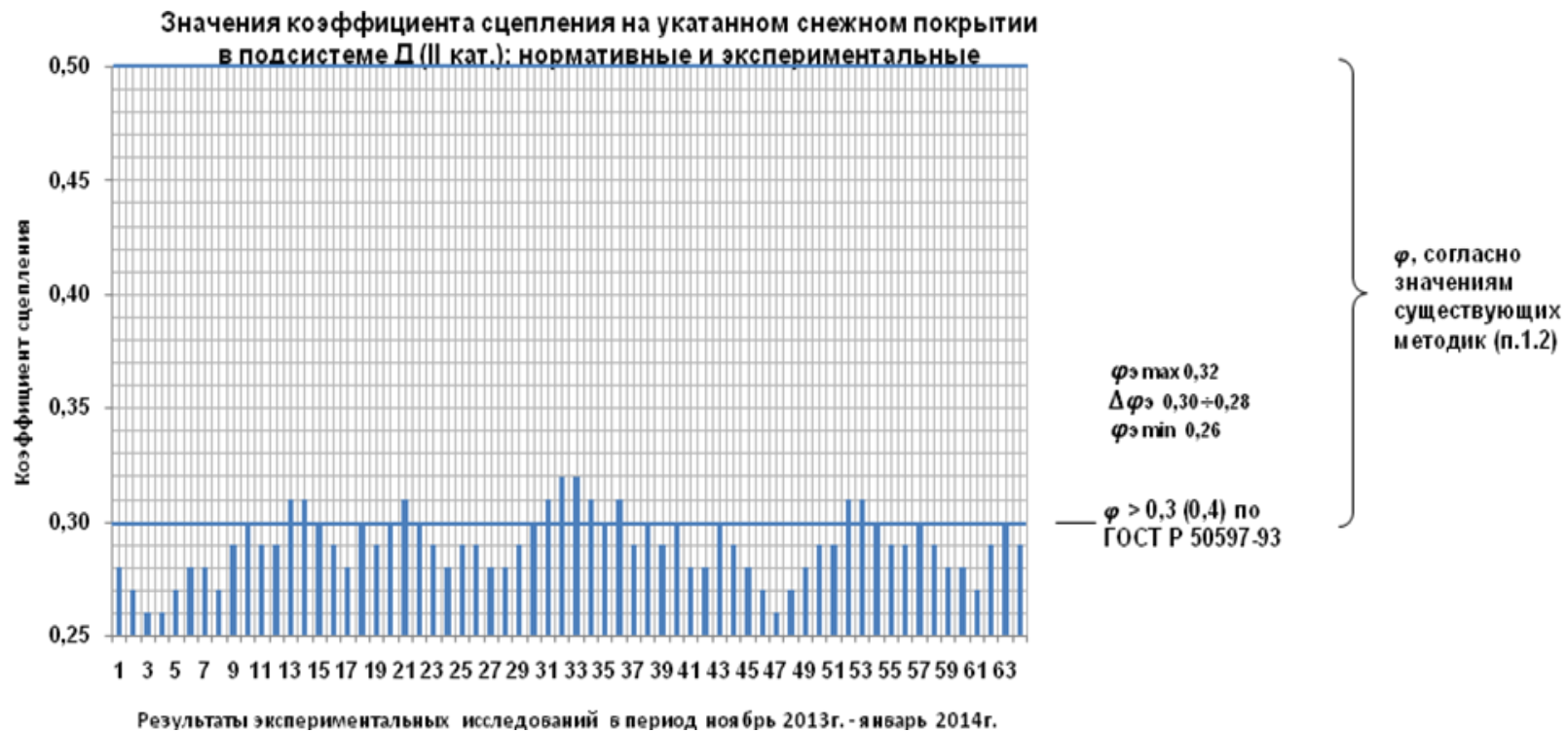
Рисунок 3.36 – Сравнение экспериментально полученных (фактических) значений коэффициента сцепления на укатанном снежном покрытии на участке подсистемы Д – участок а/д «Санкт-Петербург – завод им. Свердлова - Всеволожск» в период с ноября 2013г. по январь 2014г. с нормативными данными, значениями известных авторов и существующих методик
