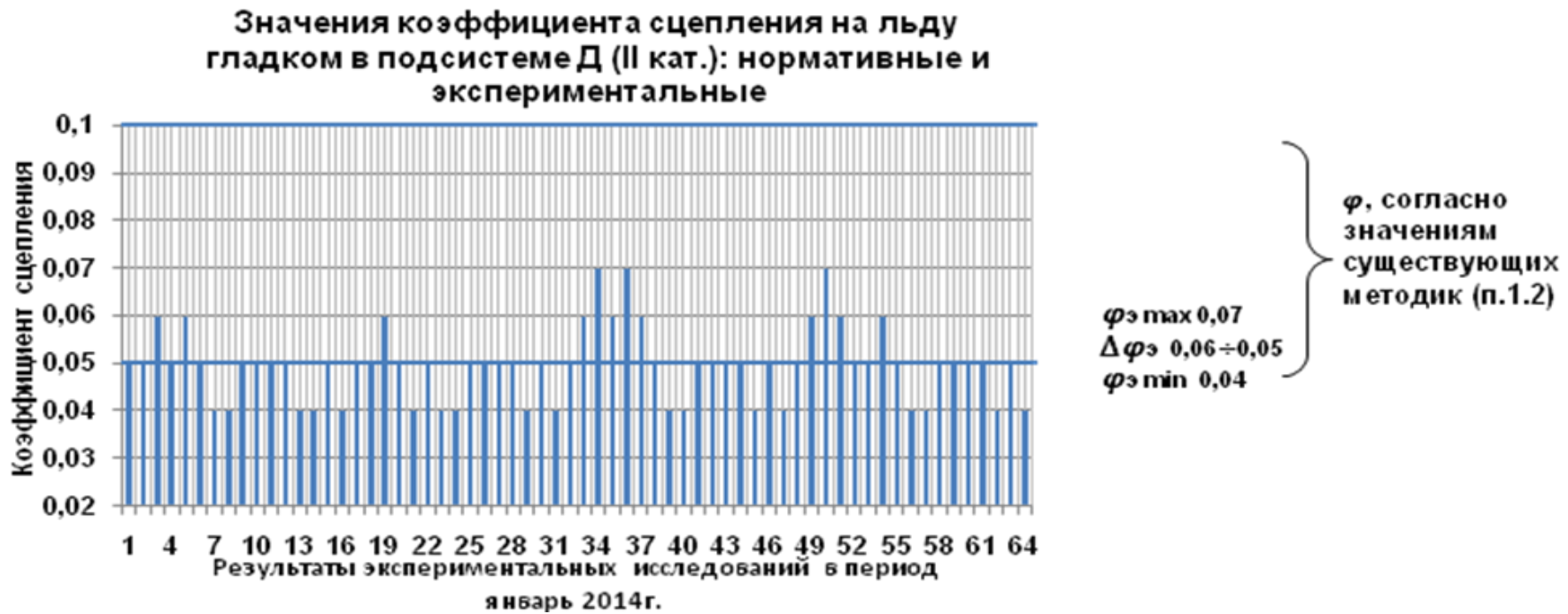
Рисунок 3.37 – Сравнение экспериментально полученных (фактических) значений коэффициента сцепления на льду гладком на участке подсистемы Д – участок а/д «Санкт-Петербург – завод им. Свердлова - Всеволожск» в период январь 2014г. с нормативными данными, значениями известных авторов и существующих методик
