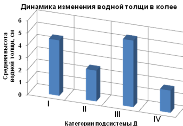
Рисунок 3.50 – Измерение водной толщи в колее экспериментальных участках в период с апреля 2013г. по ноябрь 2013г.
