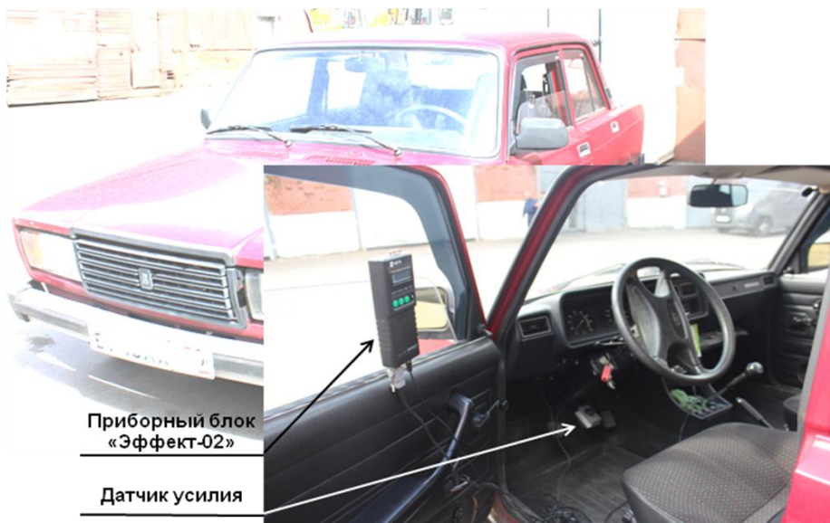
Рисунок 3.3 – Установка прибора и получение результатов исследования на а/м марки ВАЗ-2107
