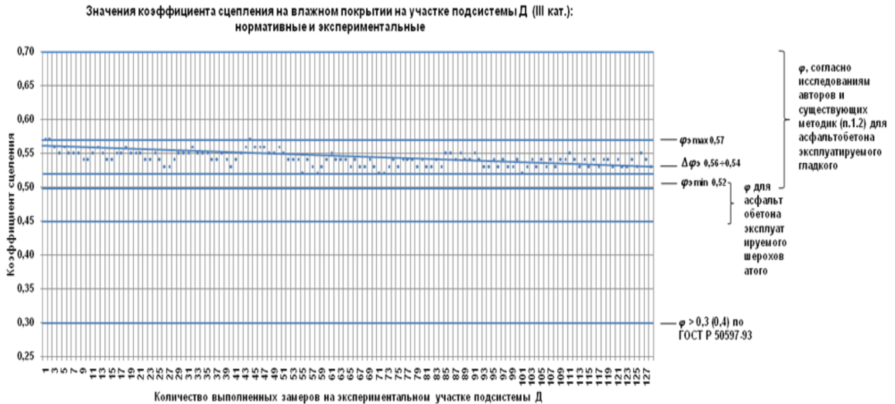
Рисунок 3.40 – Сравнение экспериментально полученных (фактических) значений коэффициента сцепления на влажном покрытии на участке подсистемы Д – участок а/д «Зеленогорск – Приморск - Выборг» в период октября по ноябрь 2013г. с нормативными данными, значениями известных авторов и существующих методик
