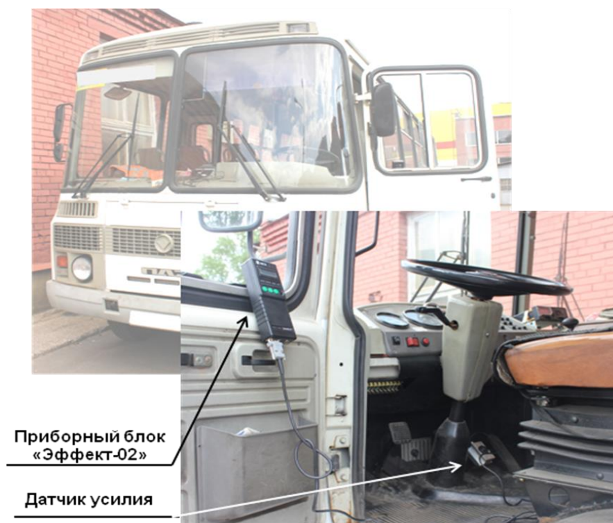
Рисунок 3.4 – Установка прибора и получение результатов исследования на автобус – ПАЗ-32053
