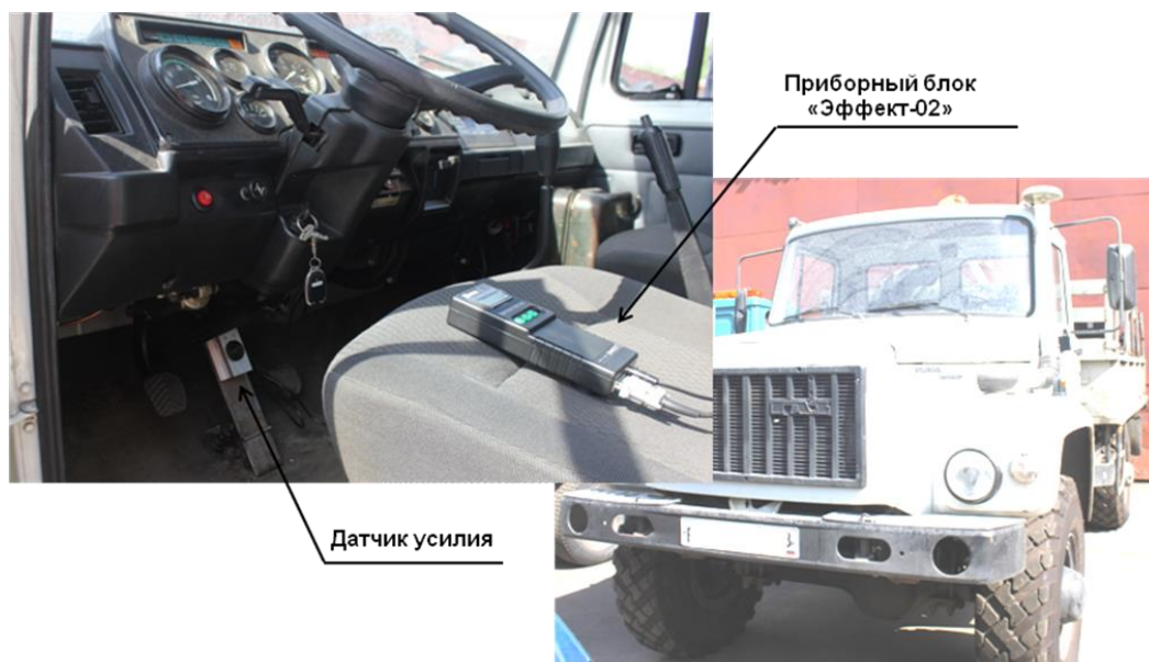
Рисунок 3.6 – Установка прибора и получение результатов исследования на а/м ГАЗ Валдай
