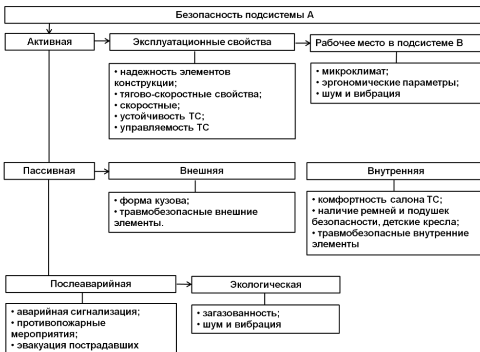
Рисунок 1.4 – Структура безопасности подсистемы А
