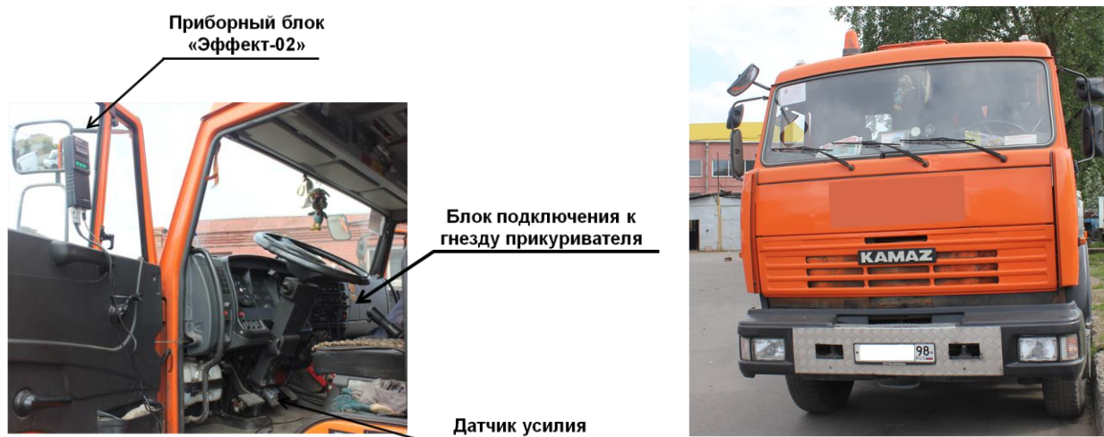
Рисунок 3.7 –Установка прибора «Эффект-02» перед проведением исследования на ТС – КАМАЗ
