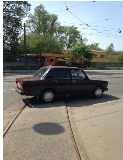
Рис. 3.29 Автомобиль марки ВАЗ-2107 в момент экстренного торможения при преодолении трамвайных путей
