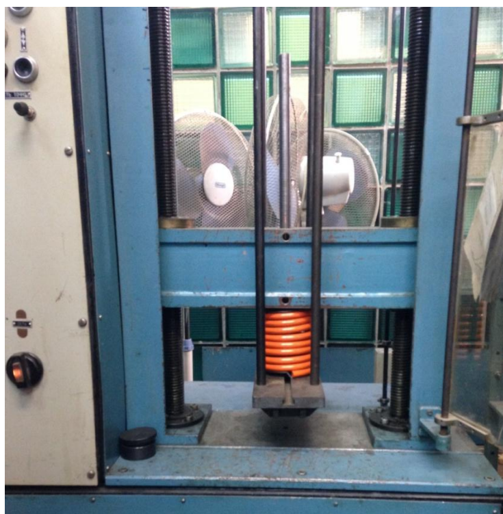
Рис. 3.13 Пружина в момент полного сжатия
