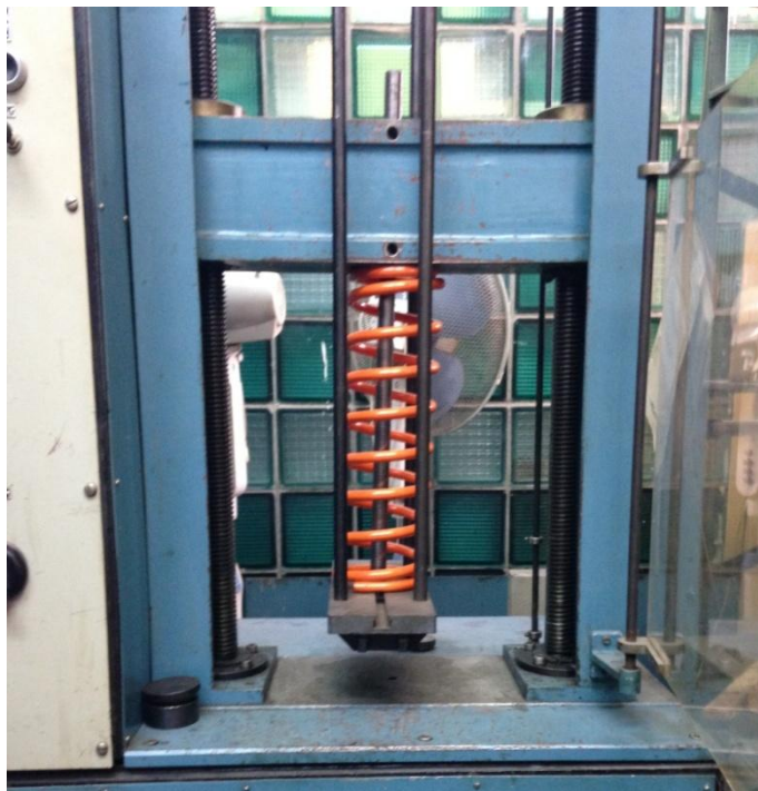
Рис. 3.12 Пружина перед началом сжатия
