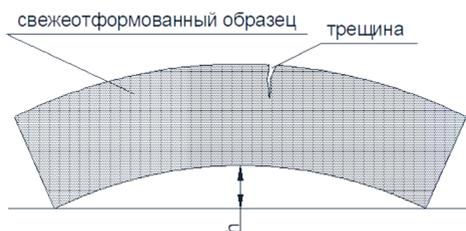
Рис. 3 – схема определения предельной растяжимости бетонной смеси (вид сверху)
