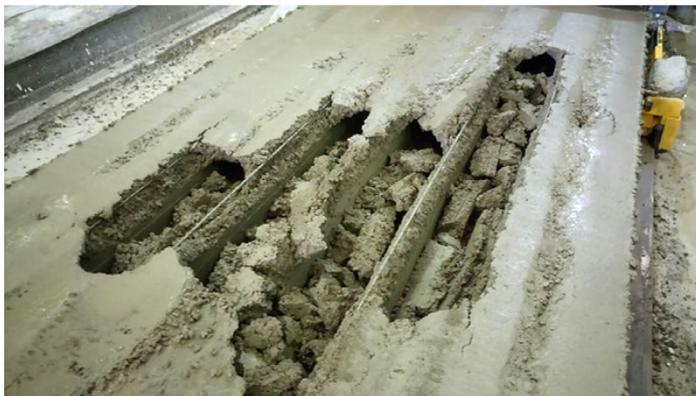
Рис. 9 – дефекты и обрушение полок свежеотформованной предварительно напряженной плиты пустотного настила
