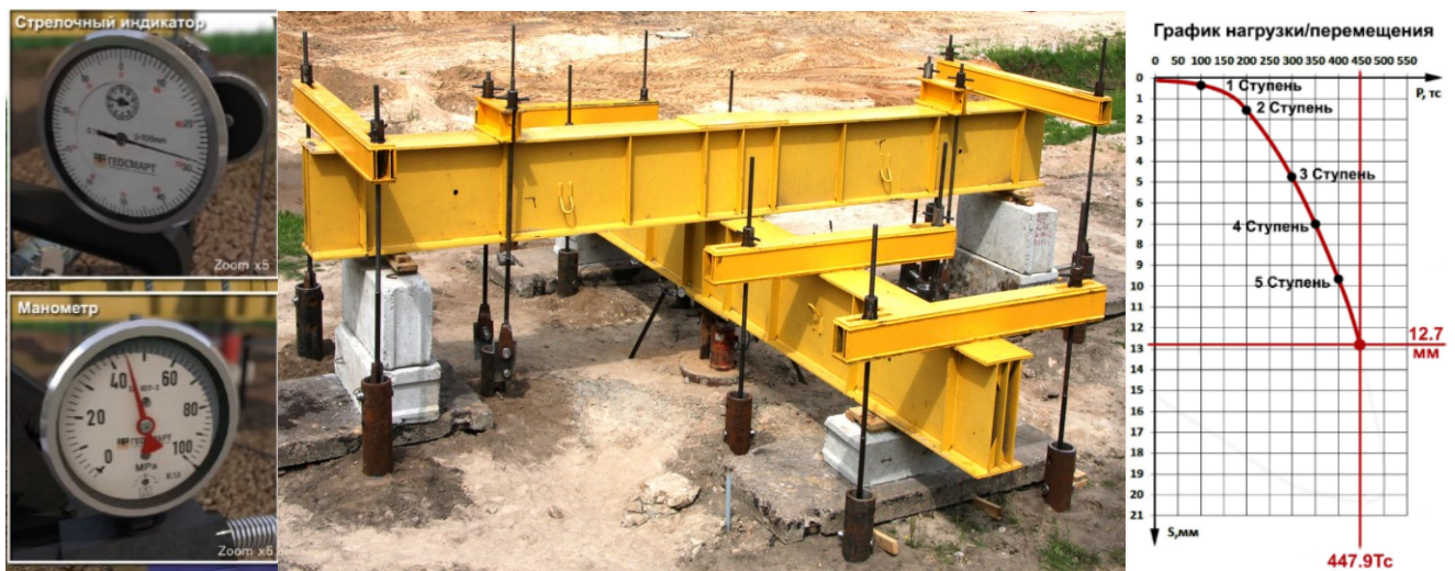
Рисунок 2.5.2. Подготовка оборудования и нагрузка подаётся ступенями
