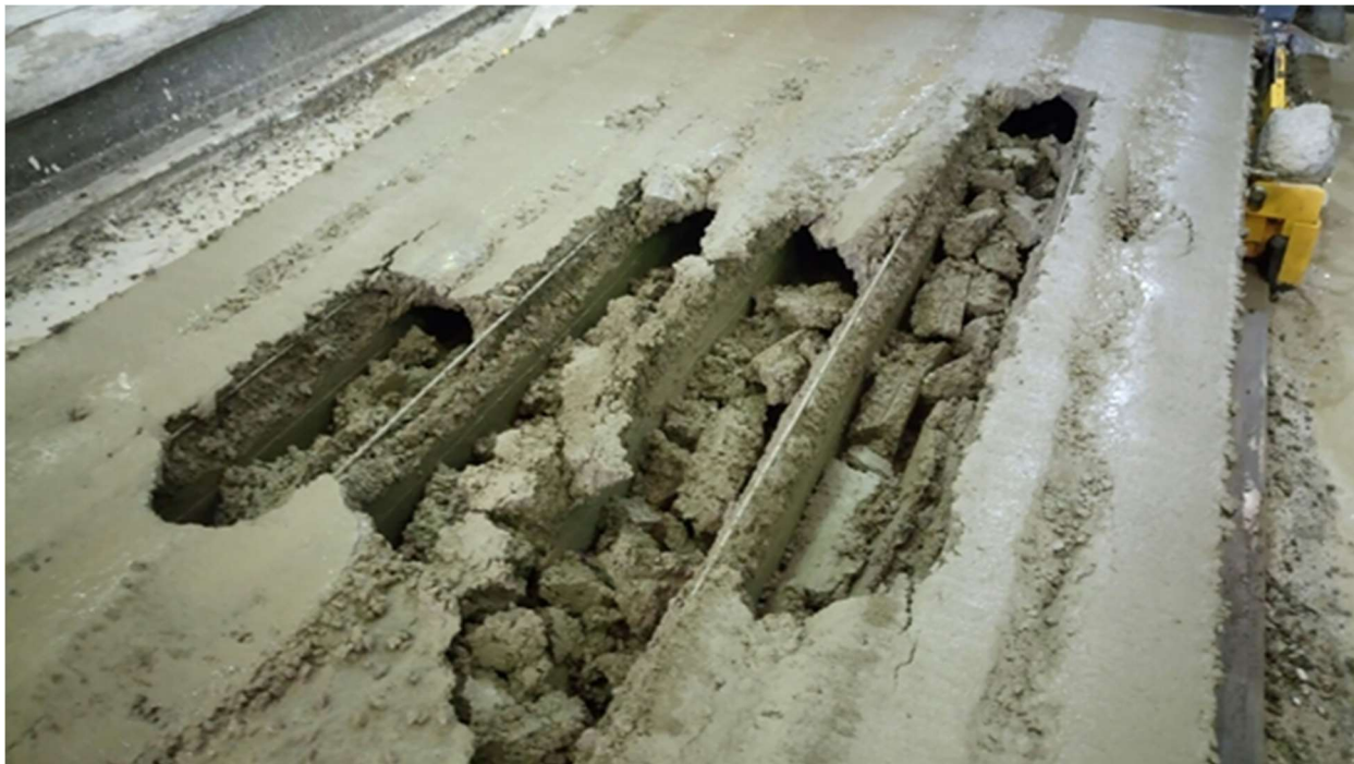
Рисунок 5.1 – Обрушение полок свежееотформованной предварительно напряженной плиты пустотного настила
