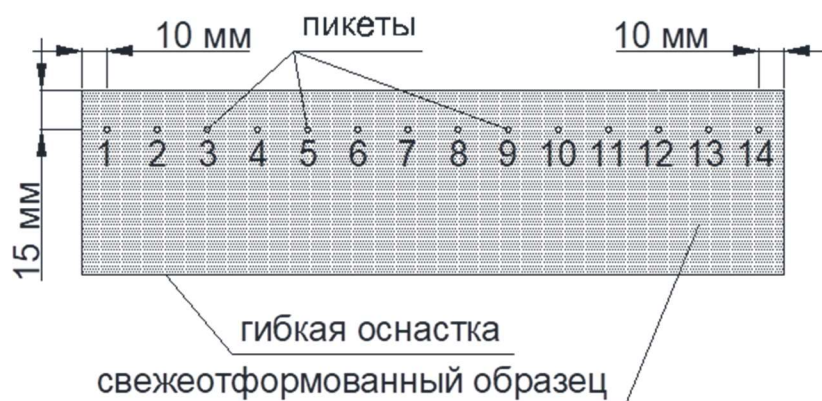
Рисунок 2.8 – Схема расположения пикетов в образце (вид сверху)
