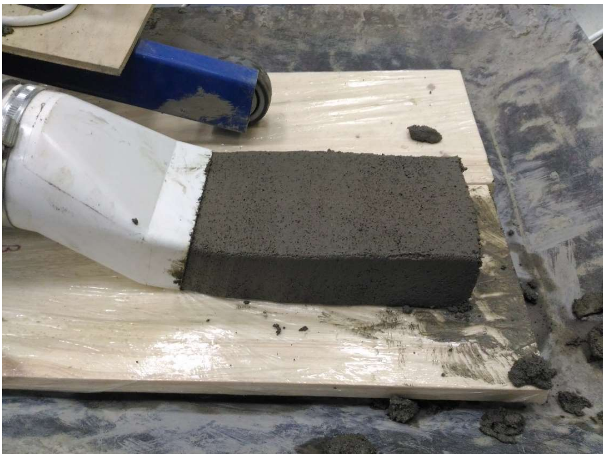
Рисунок 2.5 – Процесс формовки на лабораторном бетоноукладчике с использованием состава № 2.3
