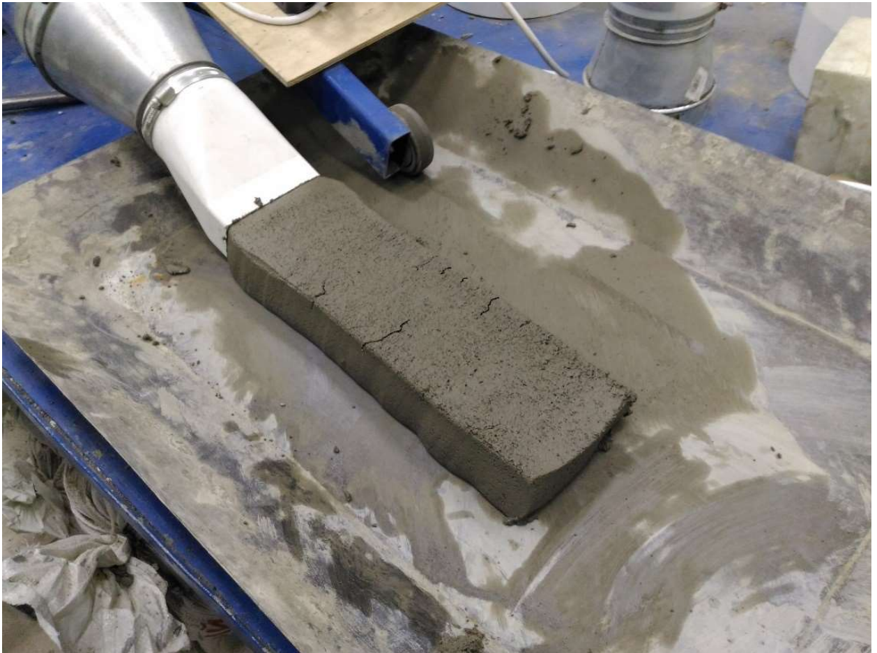
Рисунок 2.3 – Процесс формовки на лабораторном бетоноукладчике с использованием состава № 2.1
