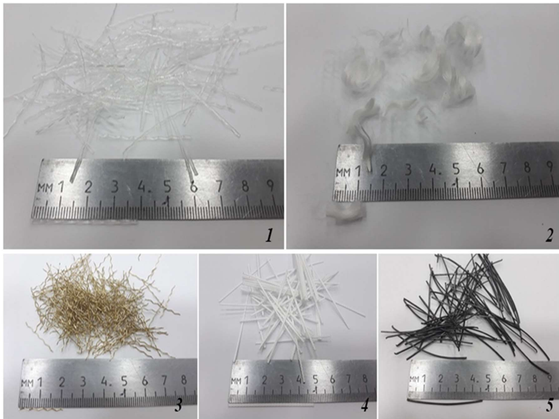
Рисунок 4.5 – используемые в исследовании армирующие волокна: 1 – волновая рубленная синтетическая фибра; 2 – Fibrin XT ; 3 – фибра «Беларусь»; 4 – Durus S500 ; 5 – рубленная проволока.
