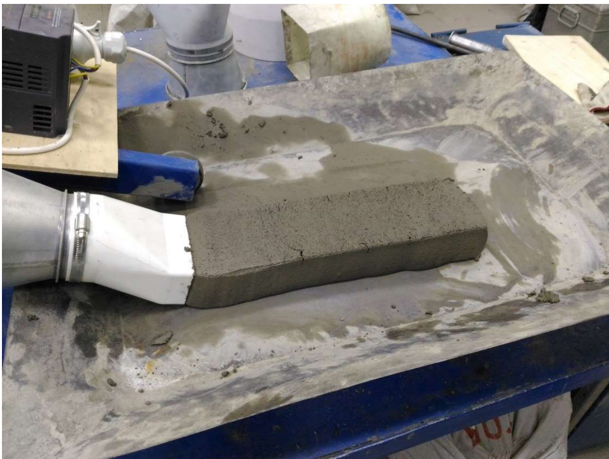
Рисунок 2.4 – Процесс формовки на лабораторном бетоноукладчике с использованием состава № 2.2
