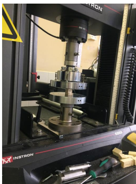
Рис. 3.2. Экспериментальное определение прочностных показателей ЛВЛ
