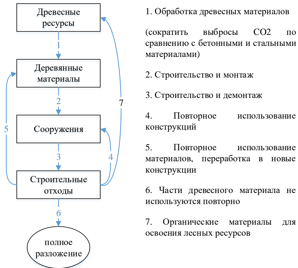
Рис. 1.1. Схемы использования древесных ресурсов в строительных работах
