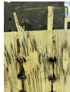
Рис. 3.29. Виды разрушения соединений деревянных конструкций ЛВЛ в различных схемах соединения
