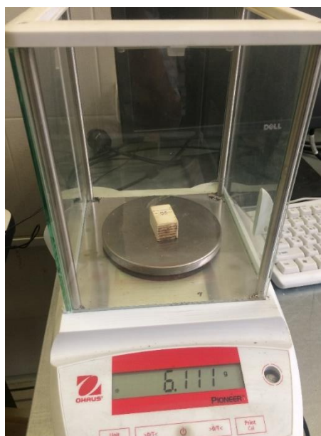
Рис. 3.1. Лабораторные весы PA413C с опытным образцом из ЛВЛ
