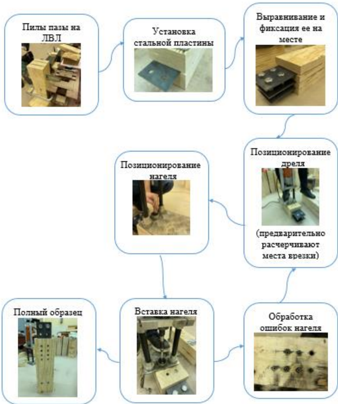
Рис. 3.24. Последовательность сборки образцов соединений конструкций из ЛВЛ с применением самонарезающих нагелей
