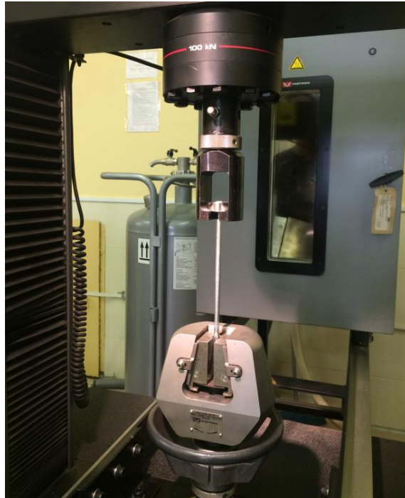
Рис. 3.5. Испытание самонарезающих нагелей на растяжение
