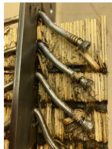
Рис. 3.29. Виды разрушения соединений деревянных конструкций ЛВЛ в различных схемах соединения
