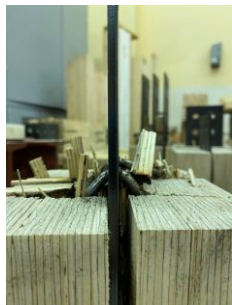
Рис. 3.29. Виды разрушения соединений деревянных конструкций ЛВЛ в различных схемах соединения
