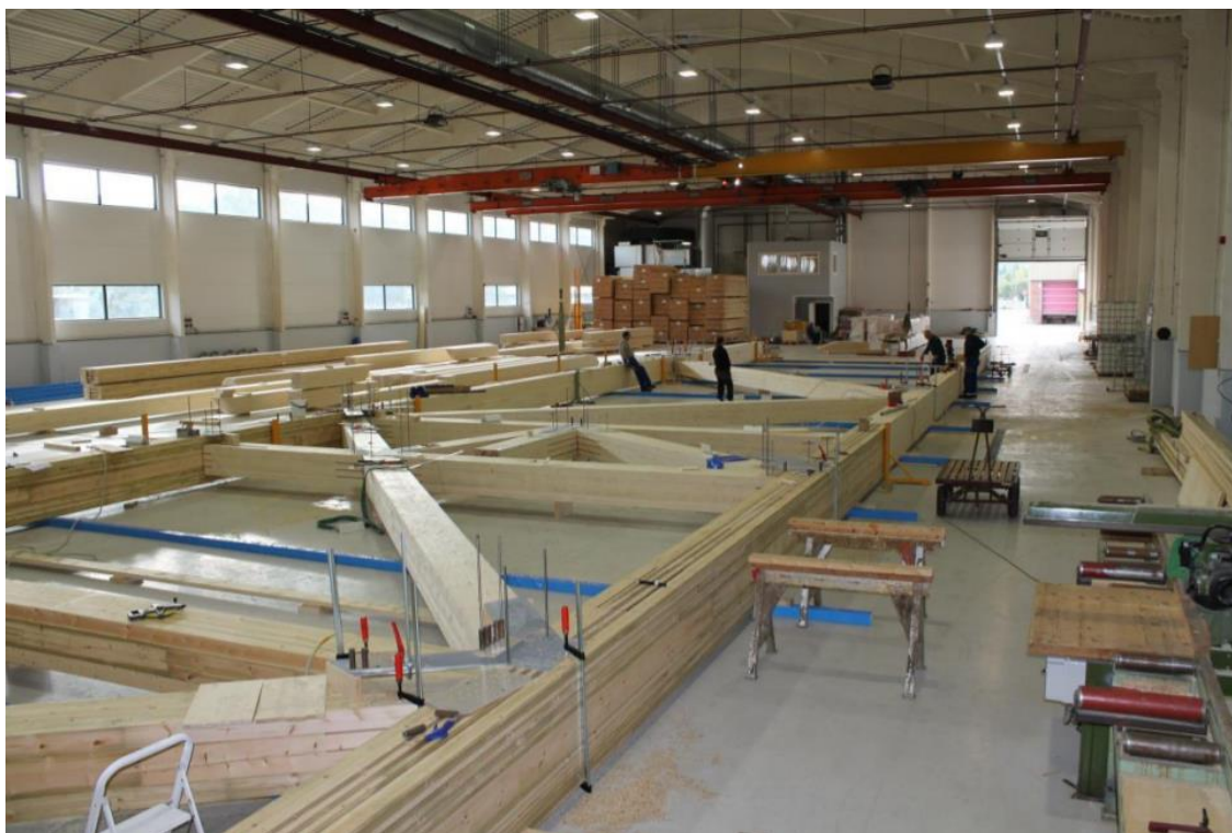
Рис. 1.6. Производство Фермы, используются соединения с применением самонарезающих нагелей
