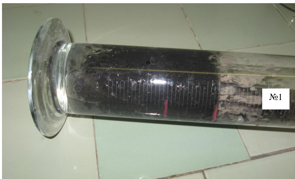
Рисунок 3.8 – Степень прилипания исходных осадков к стенкам цилиндра
