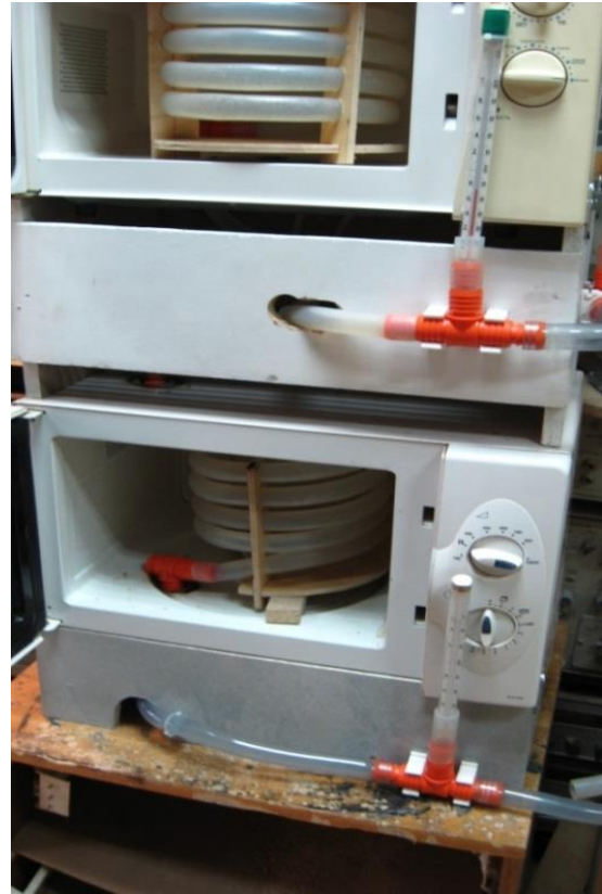
Установка СВЧ-обработки осадков (вид Б)
