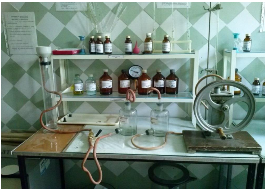
Рисунок 2.2 – Лабораторный стенд для определения удельного сопротивления осадка
