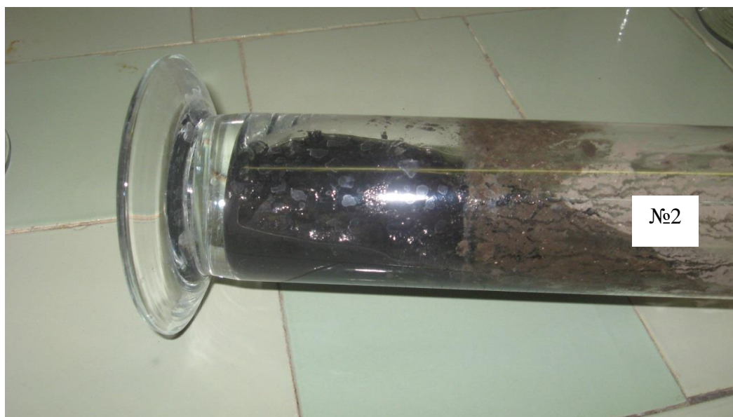
Рисунок 3.9 – Степень прилипания осадков к стенкам цилиндра после микроволновой обработки
