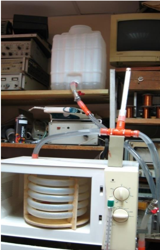
Установка СВЧ-обработки осадков (вид А)
