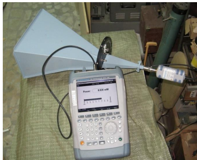
Антенна измерительная П6-59 и анализатор спектра R&S FSH8
