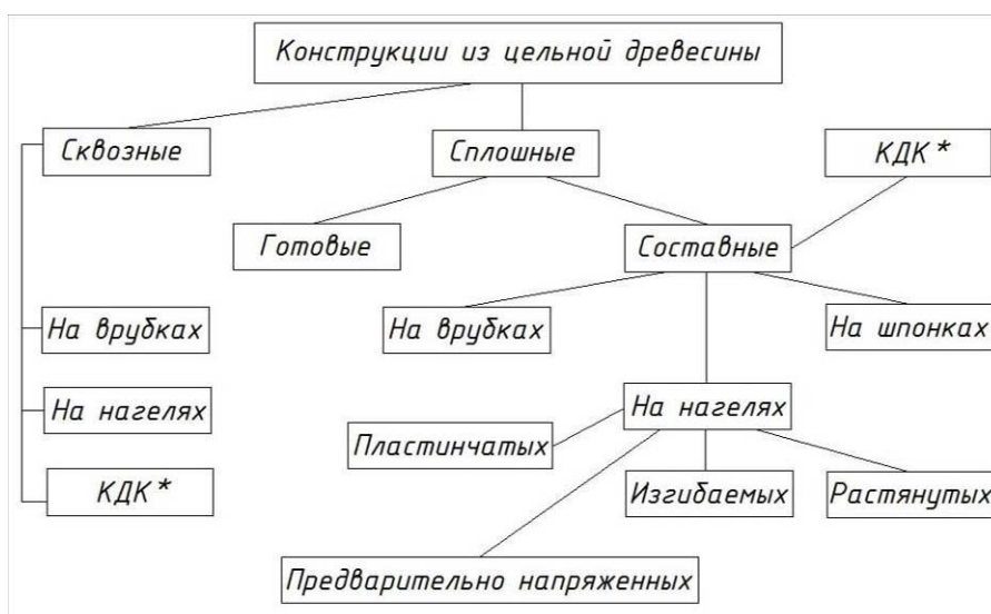
Рисунок 1.1. Классификация деревянных конструкций из цельной древесины.
