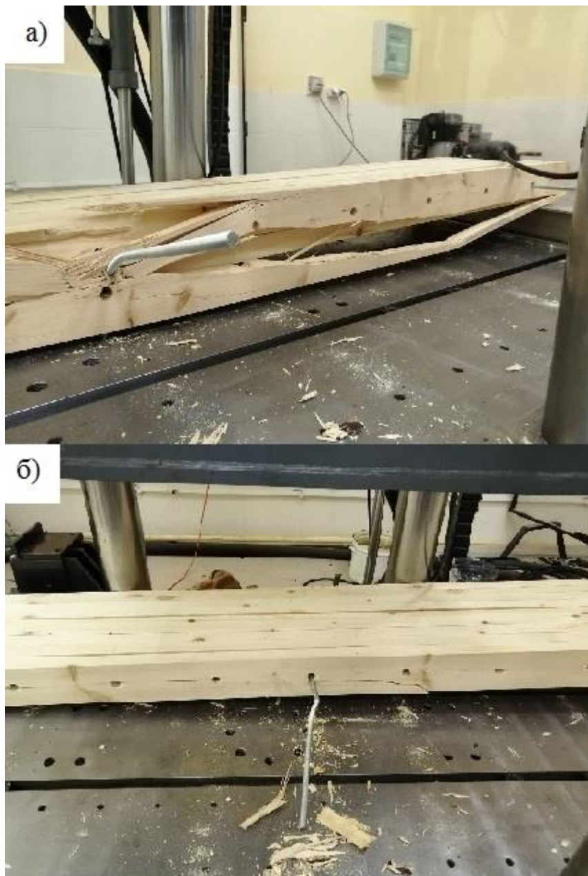
Рисунок 3.41. Разрушение образца: а) трещина в центральном элементе (нагруженном) б) трещина в элементе на границе сдвигаемой части сечения.
