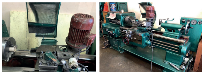
Рис. 5 – Процесс вибронакатки на внутреннем диаметре детали
