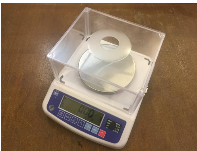
Рисунок.3.1 Лабораторные весы электронные, предел измерений до 500 г, точность – 0,01 г. (ВСТ-600/0,01)
