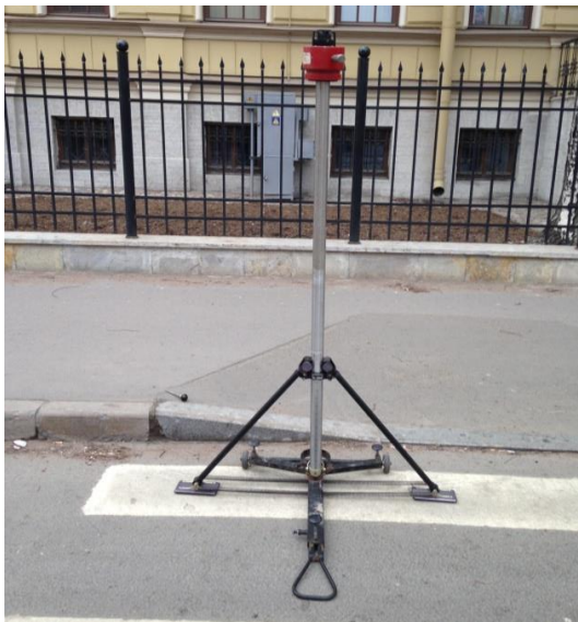
Рисунок 4.19 – Измерения на поверхности новой дорожной разметки
