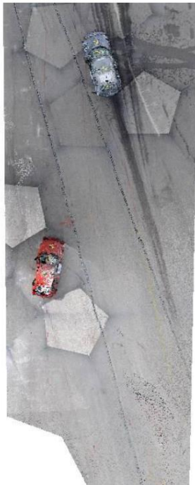
Рисунок 3.23 – Пример фотограмметрической обработки и наложения облака 3D точек полученных лазерным сканированием при получении плана сцены моделирования
