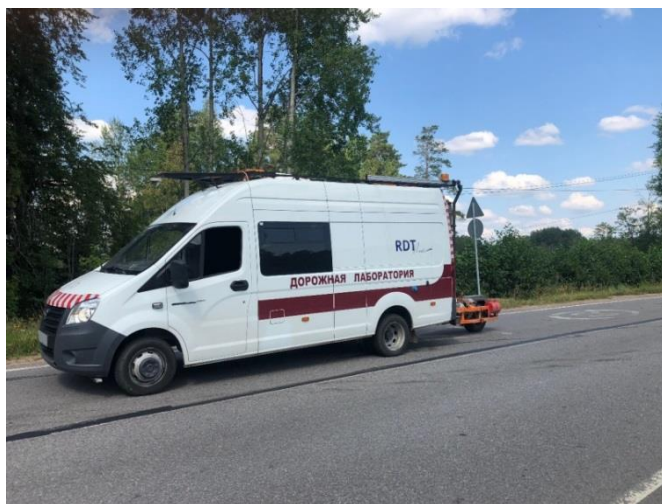
Рисунок 4.10 – передвижная дорожная лаборатория КП-514 РДТ на базе «Газель» NEXТ
