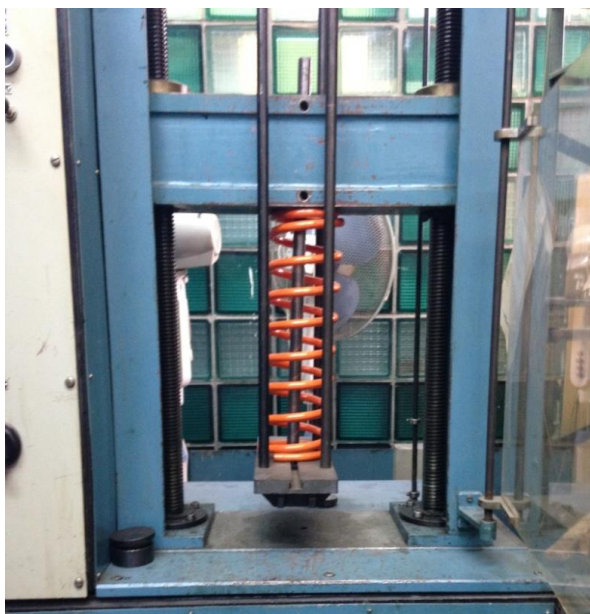
а) пружина перед началом сжатия
