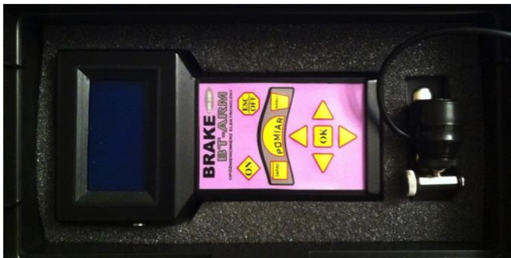
Рисунок 4.2 – Внешний вид деселерометра BRAKE TESTER модели LWS-2MC
