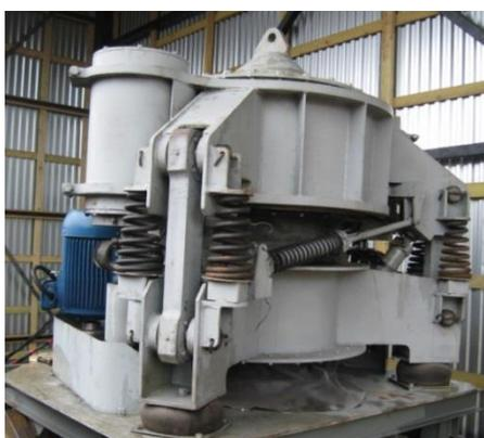
Рис. 1.12. Общий вид высокочастотной конусной вибродробилки ВКДС-700
