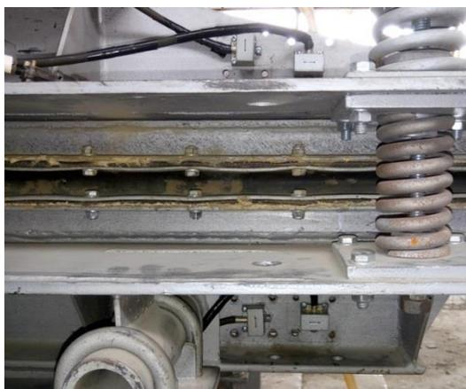
Рис. 3.4. Размещение датчиков ускорений на ТО
