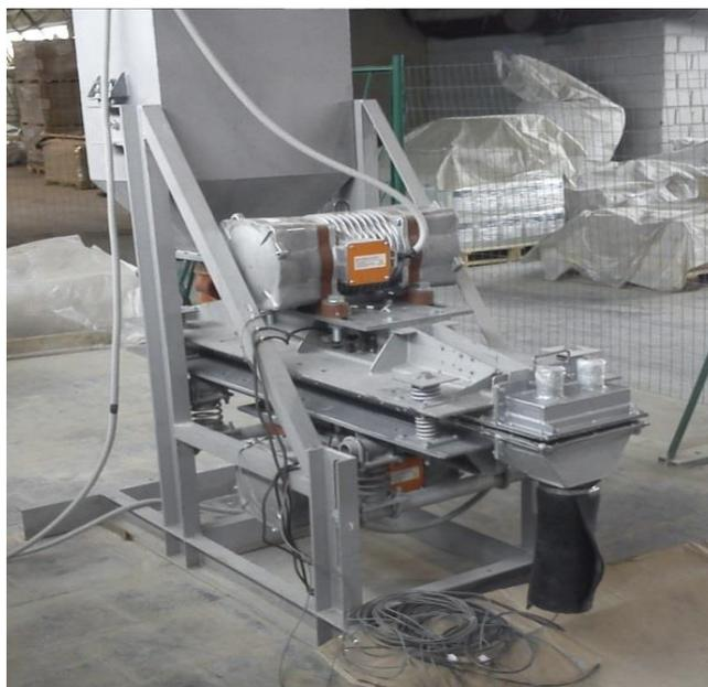
Рис. 4.1. Экспериментальная установка для оттирки и механоактивации песка.
