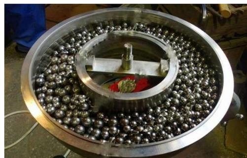
Рис. 1.6. Мельница шаровая вибрационная МВ-0,005.
