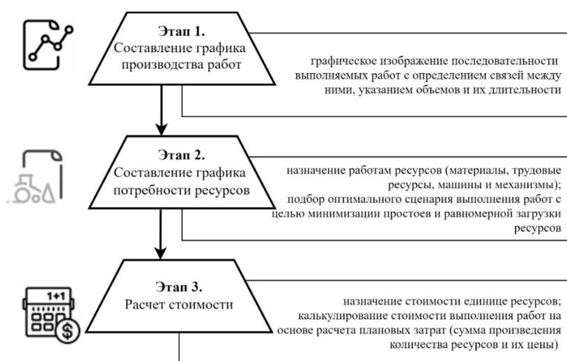
Рисунок 2 – Последовательность выполнения расчета стоимости работ затратным методом на основе графика выполнения работ
