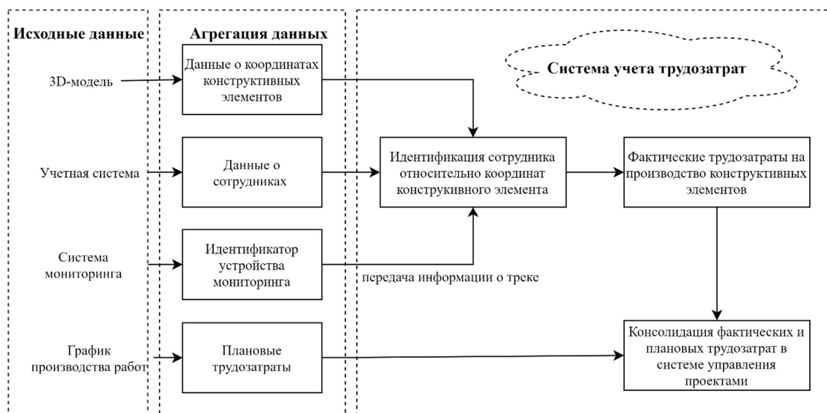
Рисунок 3 – Алгоритм формирования связи координат с носимого устройства и координат конструктива с BIM-модели
