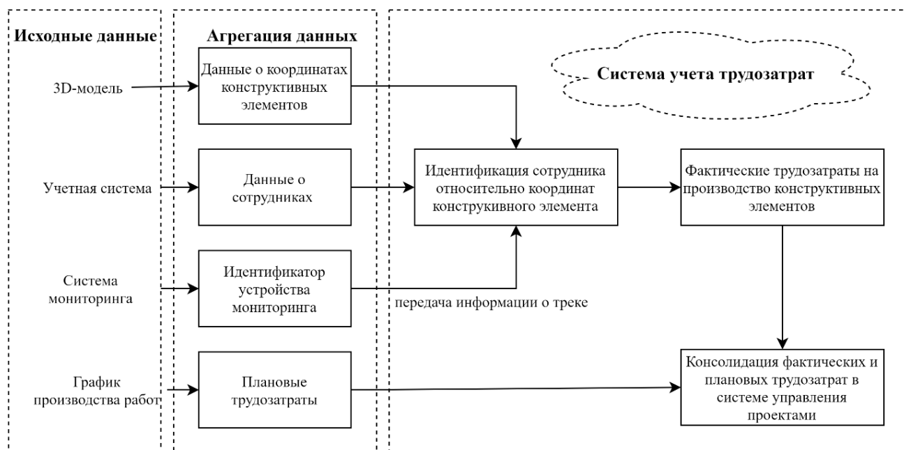
Рисунок 22 – Алгоритм формирования связи координат с носимого устройства и координат конструктива с BIM-модели
