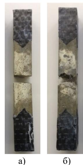
Рисунок 3 – Общий вид характерного разрушения бетонных (а) и фибробетонных (б) образцов-призм, испытанных на осевое растяжение
