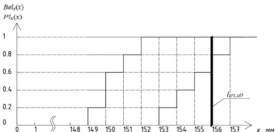
Рисунок 5 – Графический вид  $Bel_x(x)$  и  $Pl_x(x)$  для длины трещины  $X = \tilde{l}_{crc}$
