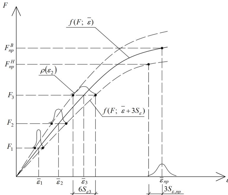
Рисунок 1 – Графическое изображение функциональной зависимости нагрузки  $F$  от относительных деформаций  $F_1^B(\bar{\varepsilon})$ ,  $F_2^H(\bar{\varepsilon} + 3S_\varepsilon)$  и условные графики плотностей вероятностей  $p(\varepsilon_i)$
