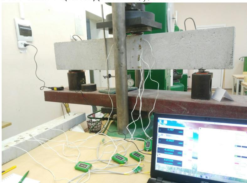
Рисунок 6 – Испытательная установка с железобетонной балкой
