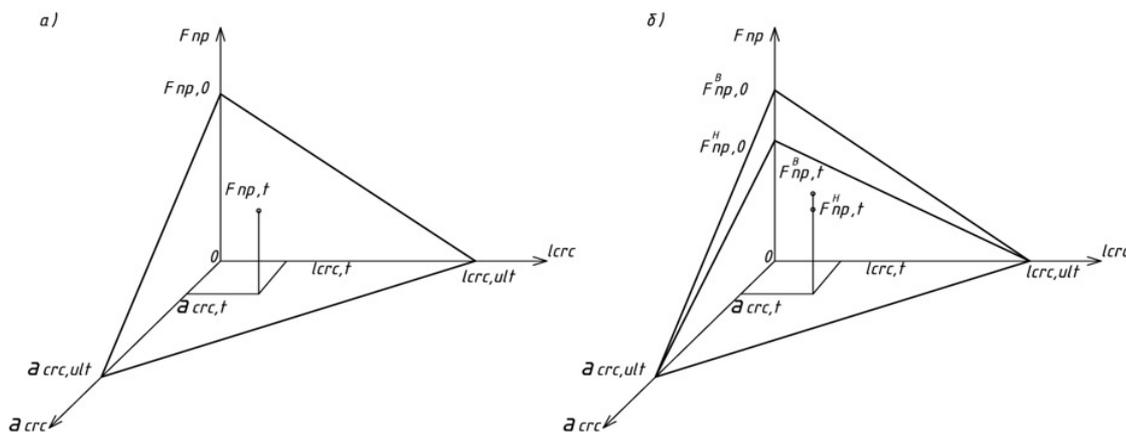
Рисунок 3 – Зависимость  $F_{np}$  от длины  $l_{crc}$  и ширины  $a_{crc}$  трещины
