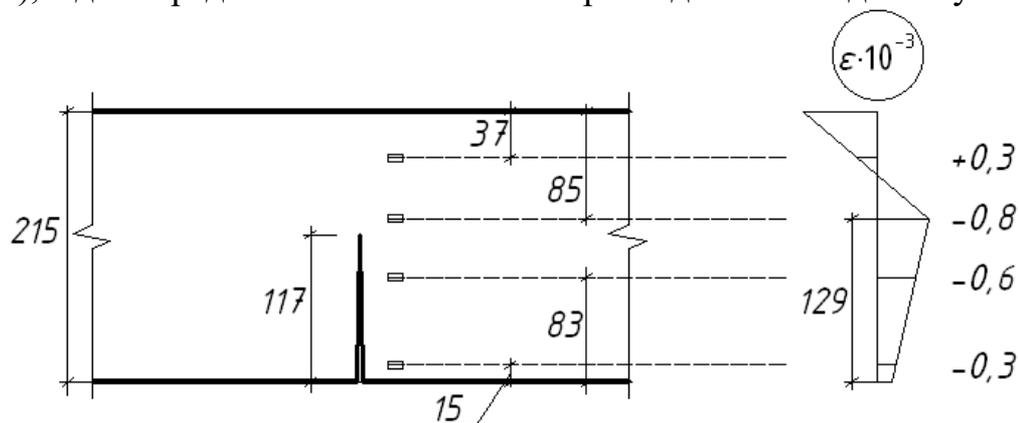
Рисунок 8 – Эпюра относительных деформаций и схема наклейки тензорезисторов вдоль длины трещины
