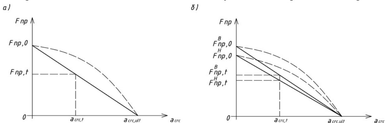
Рисунок 2 – Функциональная зависимость  $F_{np} - a_{crc}$  при  $F_{np,0}$  (а) и  $[F_{np}^H; F_{np}^B]$  (б)
