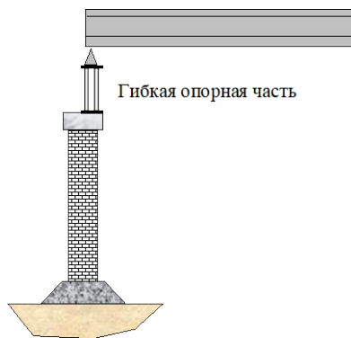
Рисунок 1.13. Опора моста с пролётным строением, использованным в качестве ДГК
