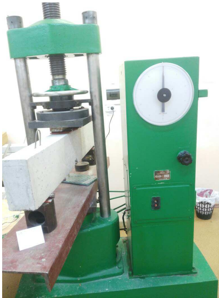
Рисунок 5.2 – Общий вид испытательной установки с гидравлическим прессом ЗИМ П-50
