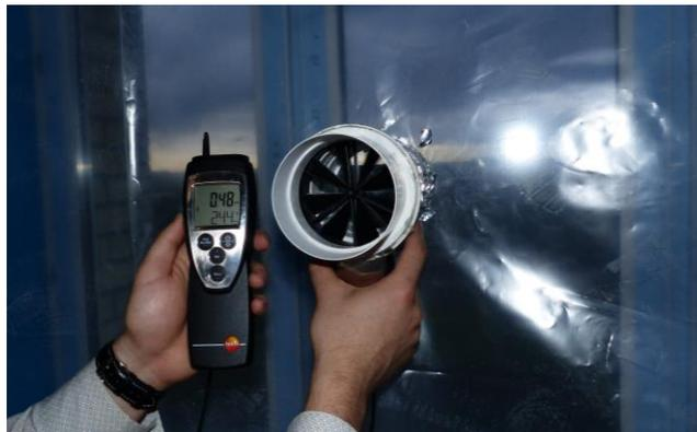
Рисунок 5.14 – Общий вид оконного блока (а) и замеры расхода воздуха через оконный блок (б) в процессе испытаний
