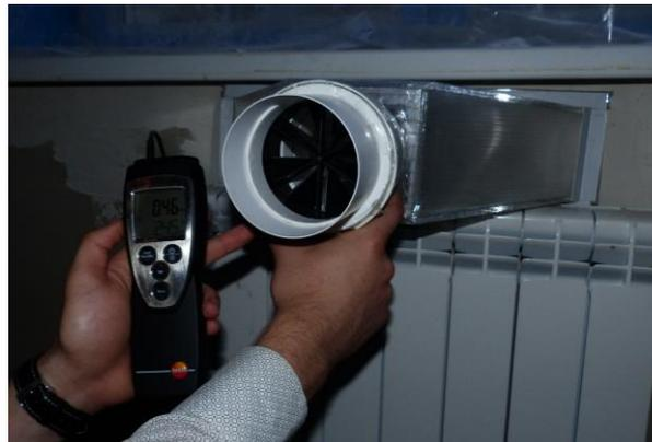
Рисунок 5.15 – Процесс замеров расхода воздуха через вытяжной канал (а) и приточный клапан (б)
