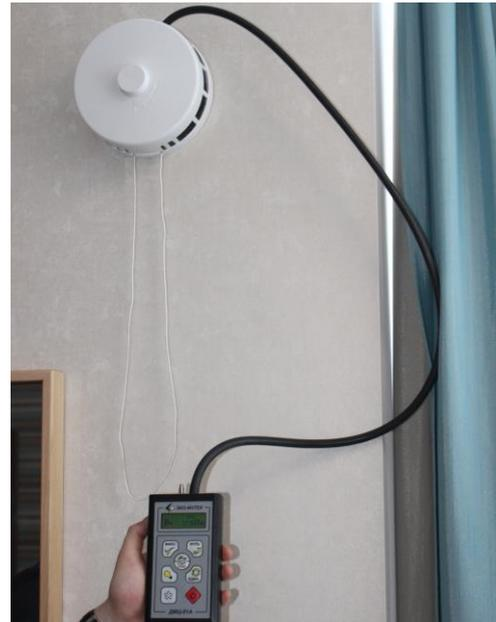
Рисунок 5.10 – Определение расхода воздуха через вытяжной канал санузла (а) и замеры перепада давлений в квартире через приточный клапан КИВ 125 (б)
