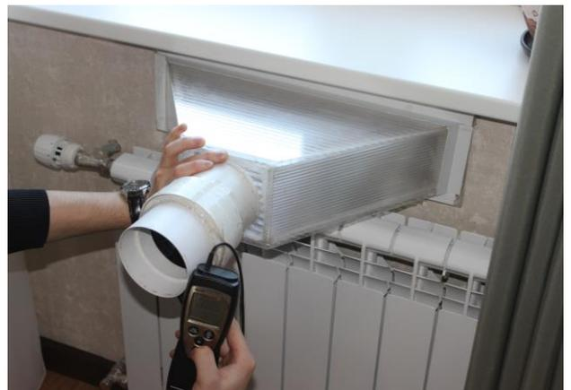
Рисунок 5.9 – Проведение замеров расхода воздуха через приточные клапаны КИВ 125 (а) и СВК В 75 (б)
