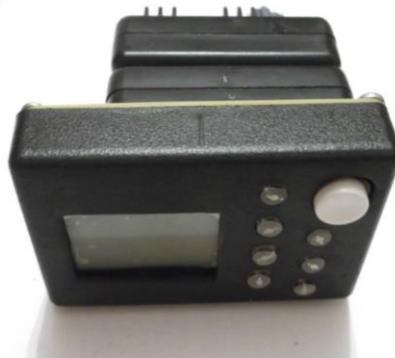
Рисунок 5.4 – Внешний вид опытного образца устройства, управляющего работой вентилятора
