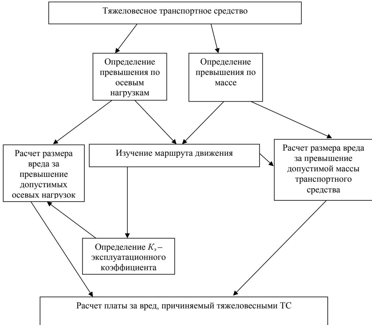
Рисунок 2.19. Последовательность расчета платы за вред, причиняемый ТС, перевозящими крупногабаритный груз
