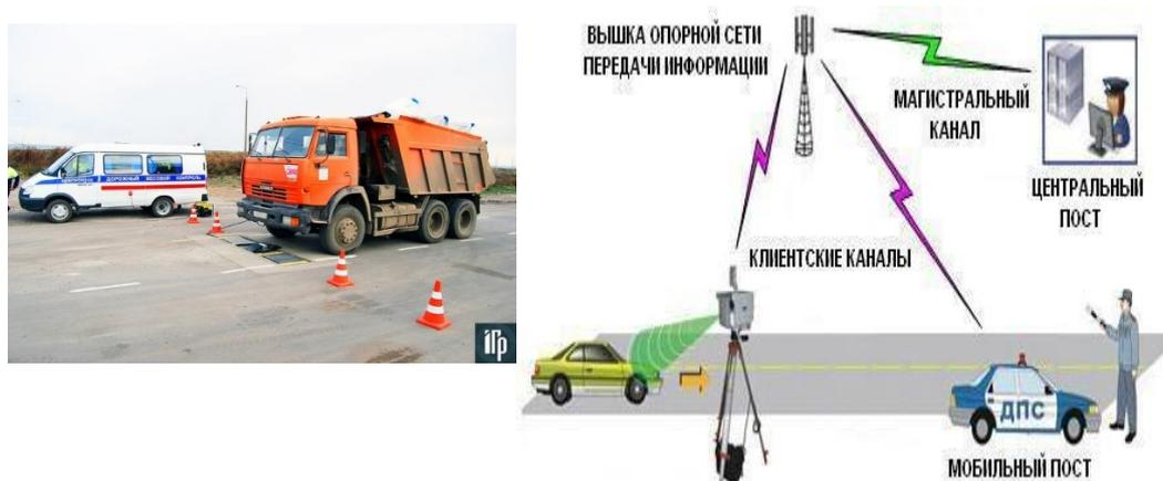
Рисунок 4.19 – Схема работы мобильного модуля идентификации
