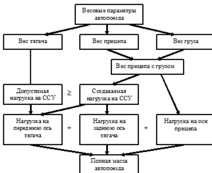
Рисунок 2.8 – Алгоритм расчета распределения весовых параметров автопоезда по осям
