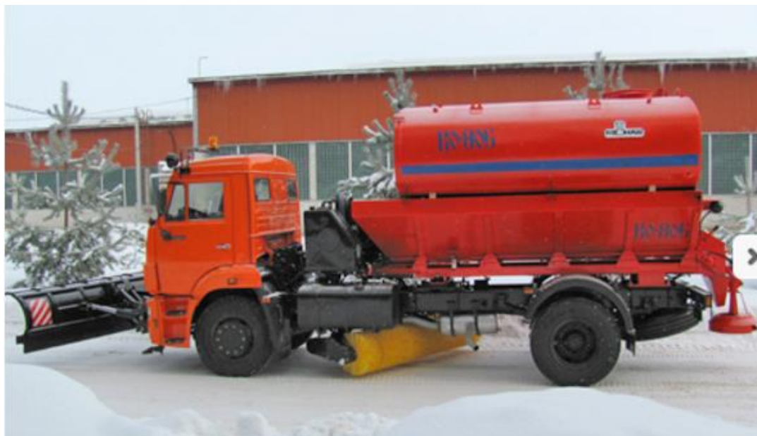
Рис. ПД.1 Коммунальная машина для содержания автомобильных дорог марки КО-806-20 с разбрасывающим, плужным и щеточным оборудованием
