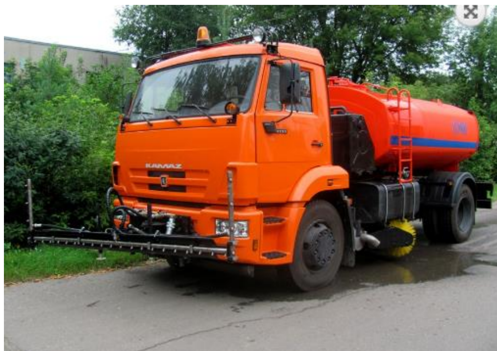
Рис. ПД.2. Коммунальная машина для содержания автомобильных дорог марки КО-806-20 с поливомоечным, плужным и щеточным оборудованием
