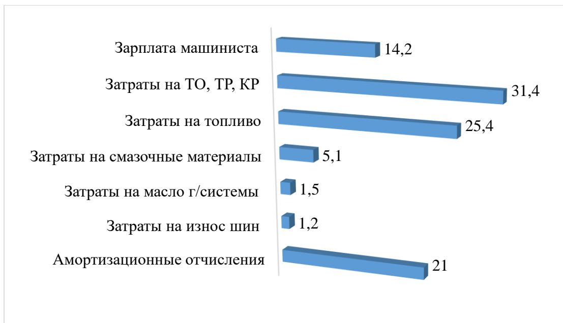
Рис. 1.6. Доли отдельных статей, входящих в эксплуатационные затраты, в процентах (ТО – техническое обслуживание; ТР – текущий ремонт; КР – капитальный ремонт)
