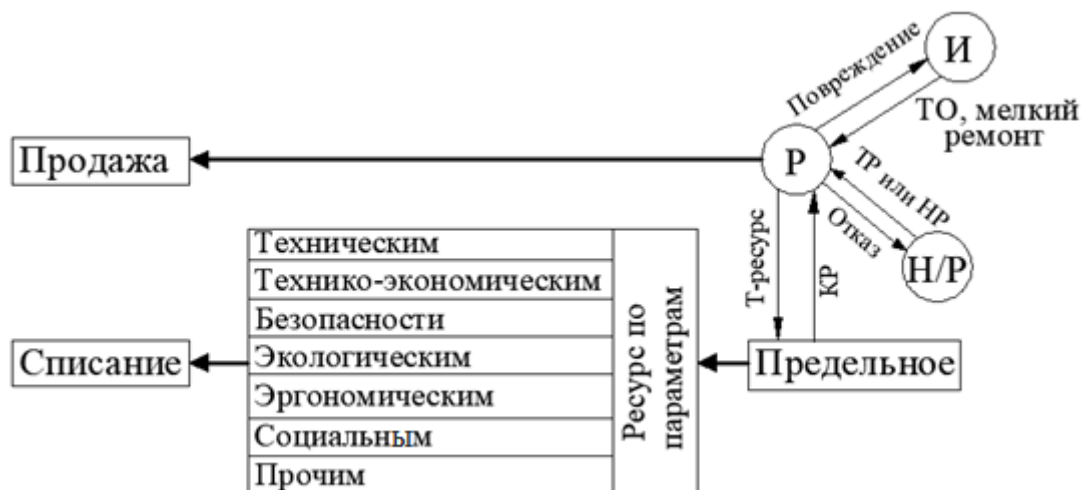
Рис. 1.7. Динамика состояний единицы машин для содержания дорог и ресурсные параметры. Н/Р – неработоспособное, И – исправное, Р – работоспособное состояния; ТР – текущий ремонт, НР – неплановый ремонт, КР – капитальный ремонт; Т-ресурс - техресурс.
