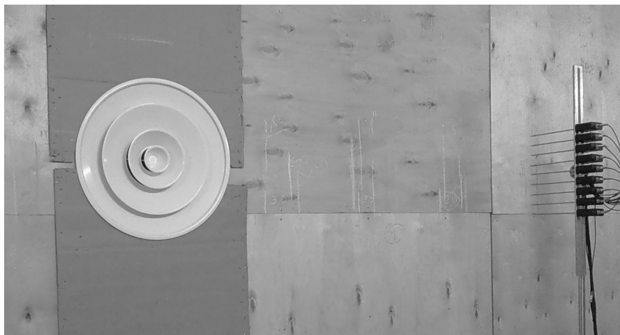
Рисунок 2.9 – Аэродинамические испытания диффузора ДКУ
