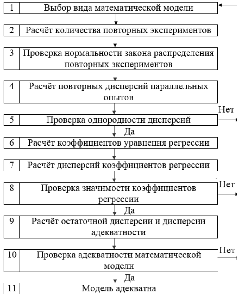
Рисунок 3.4. Схема проведения многофакторного эксперимента
