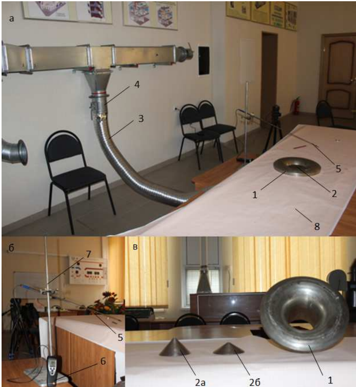
Рисунок 3.6. Экспериментальная установка: а) общий вид экспериментальной установки; б) измерительный прибор; в) элементы устройства снижения пылеобразования: 1 – подающий патрубок с тороидальной поверхностью; 2 – конусный разделитель потока: а – с высотой 60 мм, б – с высотой 40 мм; 3 – воздуховод вентиляционной сети; 4 – воздушный регулирующий клапан; 5 – измерительный зонд; 6 – термоанемометр; 7 – штатив; 8 – координатная сетка (миллиметровка);
