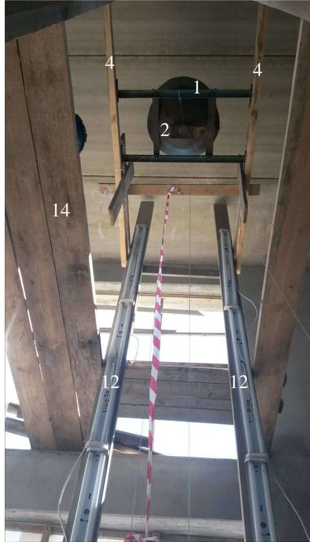
Рисунок 3.2 – Внешний вид экспериментального стенда (Вариант А): а – скользящий держатель с видеокамерой; б – общий вид
