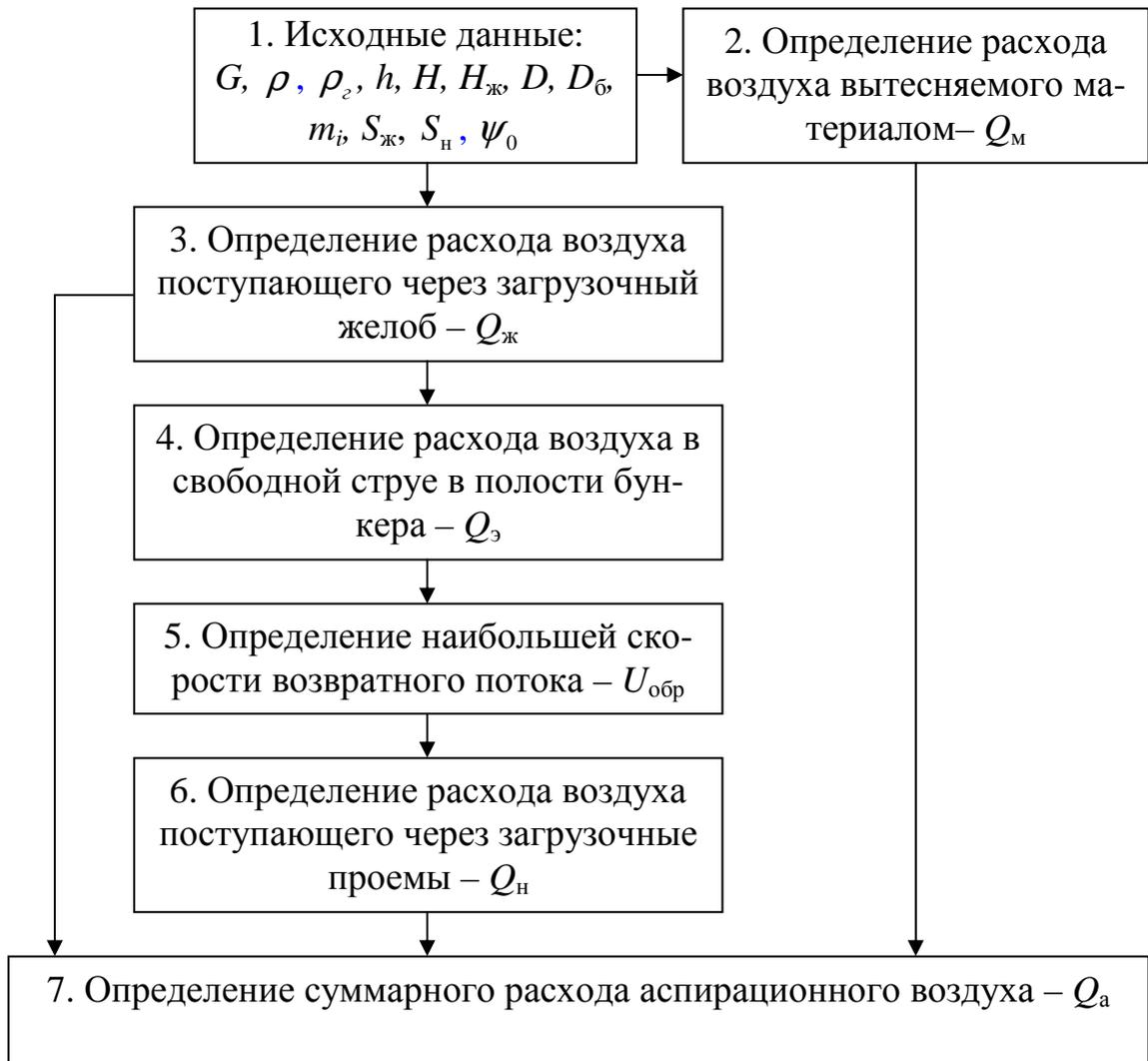
Рисунок 4.1 Алгоритм определения расхода аспирационного воздуха
