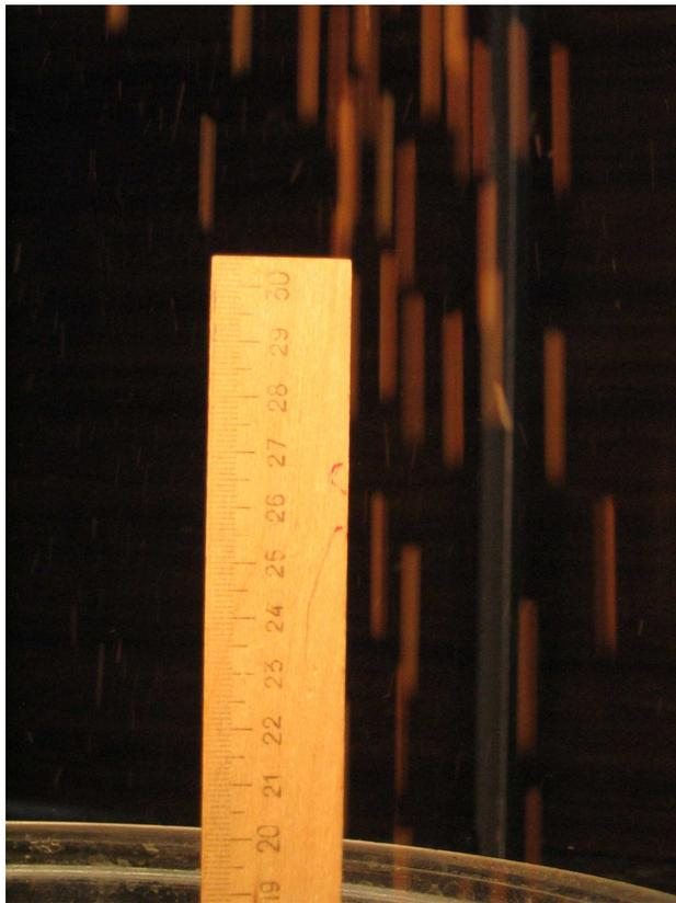
Рисунок 3.7 – Фотографический способ определения скорости движения частиц
