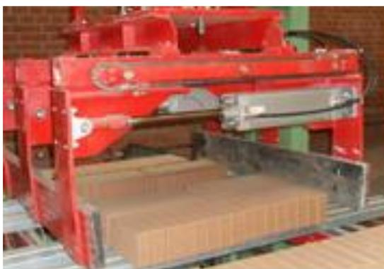
Рис. 5. 18. Укладчик-автомат (Укладчик 2)
