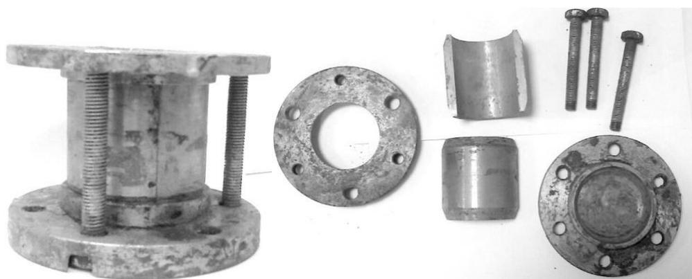
Рис. 2. 2. – Форма для изготовления образцов из гиперпрессованного цементного камня и бетона
