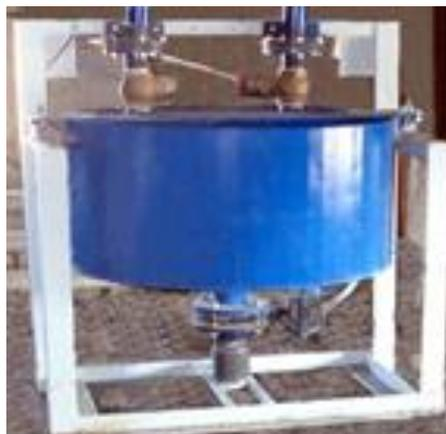
Рис. 5.11. Емкость-дозатор воды
