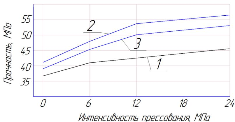
Рис. 3. 19 - Влияние на прочность гиперпрессованного бетона (ЦЕМ II/A-K (Ш-П) 42.5 Н) совместного действия дисперсного армирования и пластифицирующей добавки; 1 – контрольные образцы; 2 - образцы из армированного бетона с расходом фибры 1,5% от количества цемента и пластификатора 0,5%; 3 – то же, количество фибры – 3% и добавки 1%
