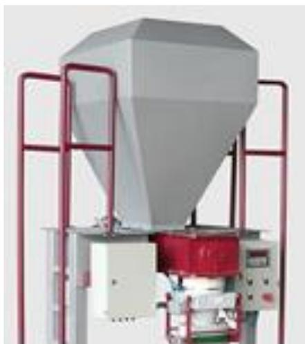
Рис. 5.6. Бункер-дозатор цемента/песка
