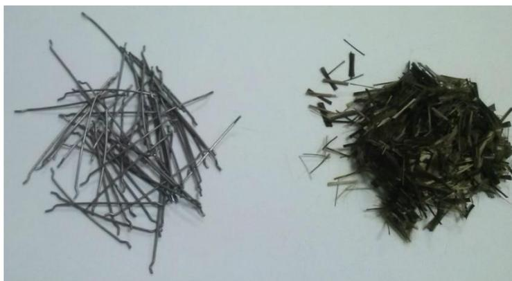
Рис. 2.1 – Металлическая фибра (а) и базальтовые волокна (б)
