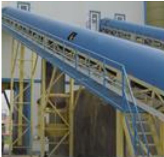
Рис. 5.2. Наклонный транспортёр щебня
