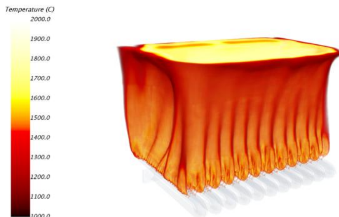
Рисунок 10 – Аксонометрия температурного поля процесса горения
